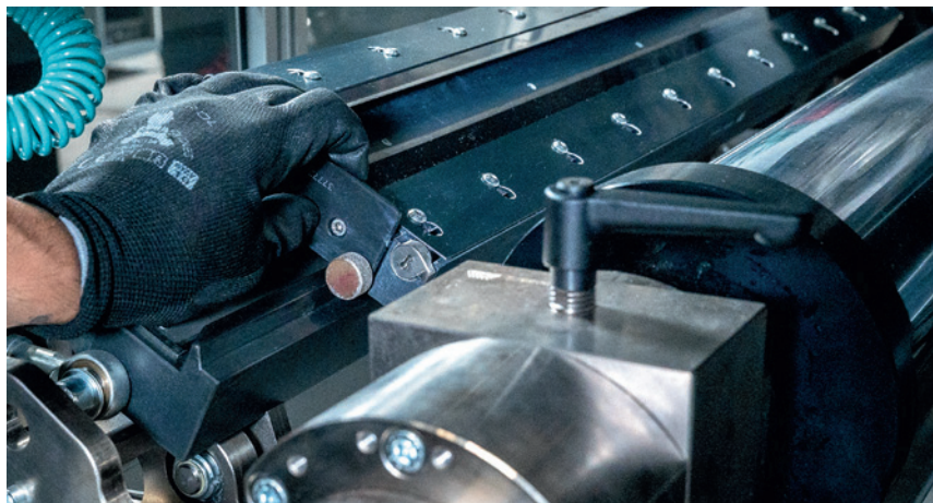
Szybka i nie powodująca powstawania zabrudzeń wymiana rakli komorowych dzięki zaawansowanemu systemowi zacisków
