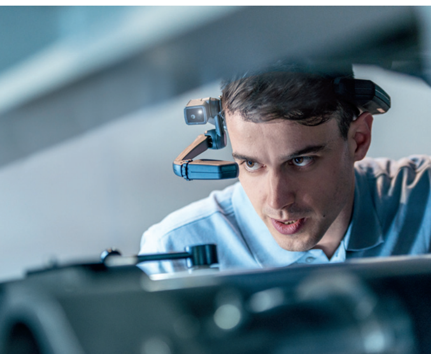
AR-DataGlass – system zdalnej konserwacji Państwa maszyny drukującej
