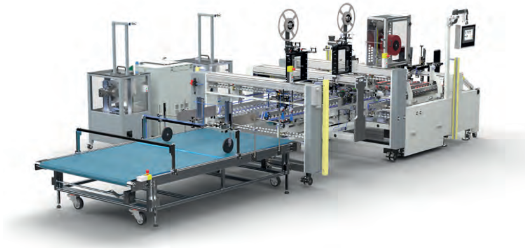
System InterHST (aplikacja taśm silikonowych) przy wprowadzeniu opakowań po jednostce nakładającej opakowania
