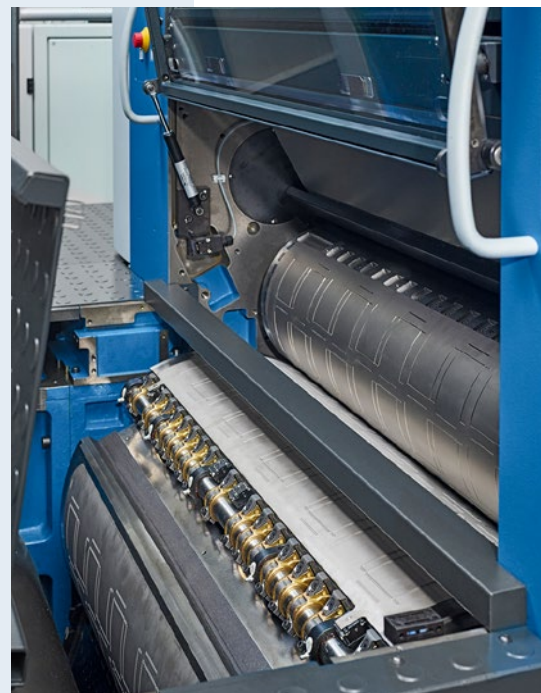
Los cuerpos de procesos de la troqueladora rotativa se basan en los conocidos módulos Rápida
