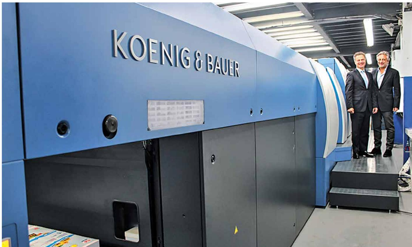
de impresión, la Rapida 106 está equipada con ErgoTronic ColorControl. Se usan tiras de medición pequeñas de tan solo 3 mm de altura. De este modo, el formato de pliego se puede aprovechar de forma óptima para la impresión. La regulación del registro se realiza a través de ErgoTronic ICR.
