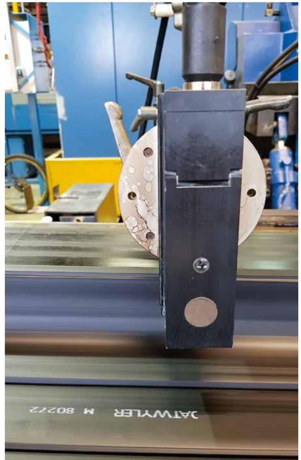
La impresora de chorro de tinta alphaJET se encarga de la rotulación de los perfiles
