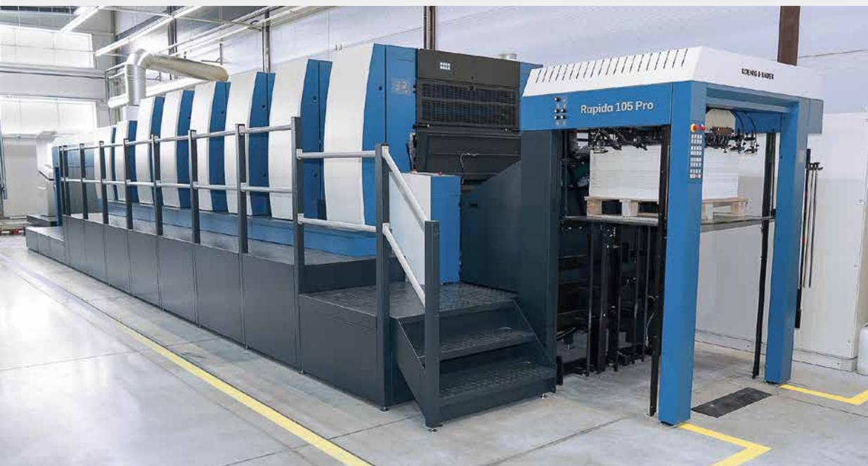
La nueva Rapida 105 PRO de seis colores con torre de laca, prolongación de la salida y cambiadores de planchas FAPC produce en una flamante nave de producción
