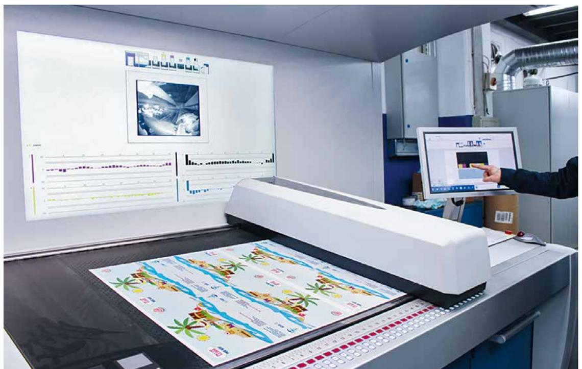
Mediante ErgoTronic ColorControl, se regula la calidad de impresión en el puesto de mando de la Rapida 106
