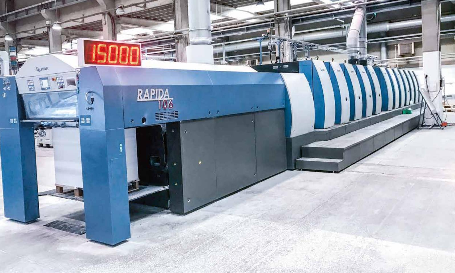
**La Rapida 106 altamente automatizada de Koenig & Bauer, equipada con ocho cuerpos de impresión y el sistema de medición de la tinta inline QualiTronic ColorControl, permite imprimir y lacar tanto el anverso como el reverso en una sola pasada con una velocidad de hasta 15.000 pliegos/hora**
