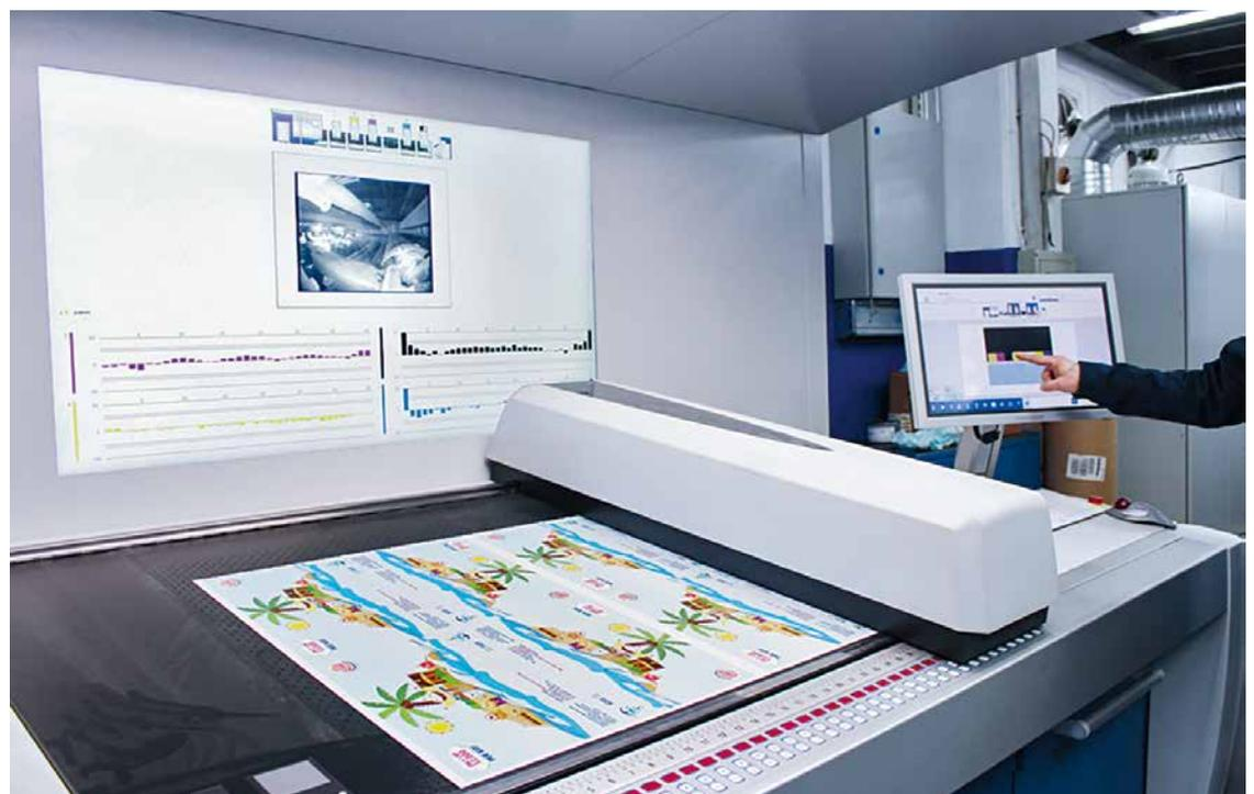
Mit ErgoTronic ColorControl wird die Druckqualität am Leitstand der Rapida 106 geregelt
