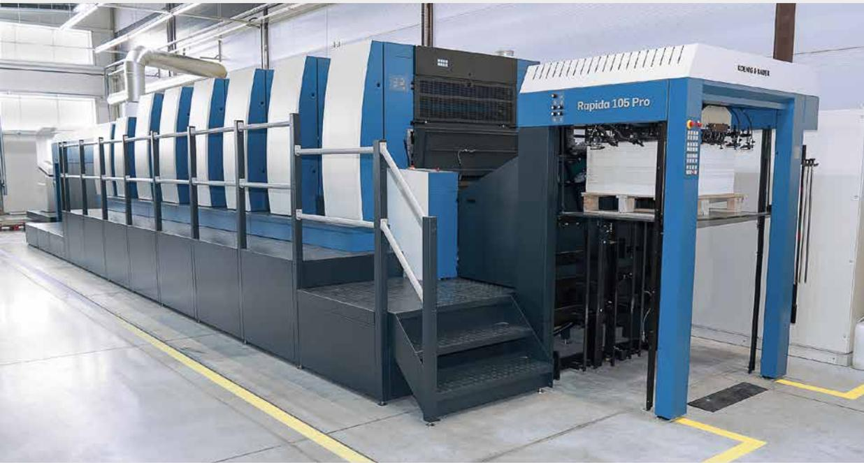
Die neue Sechsfarben-Rapida 105 PRO mit Lackturm, Auslageverlängerung und FAPC-Plattenwechslern produziert in einer nagelneuen Produktionshalle
