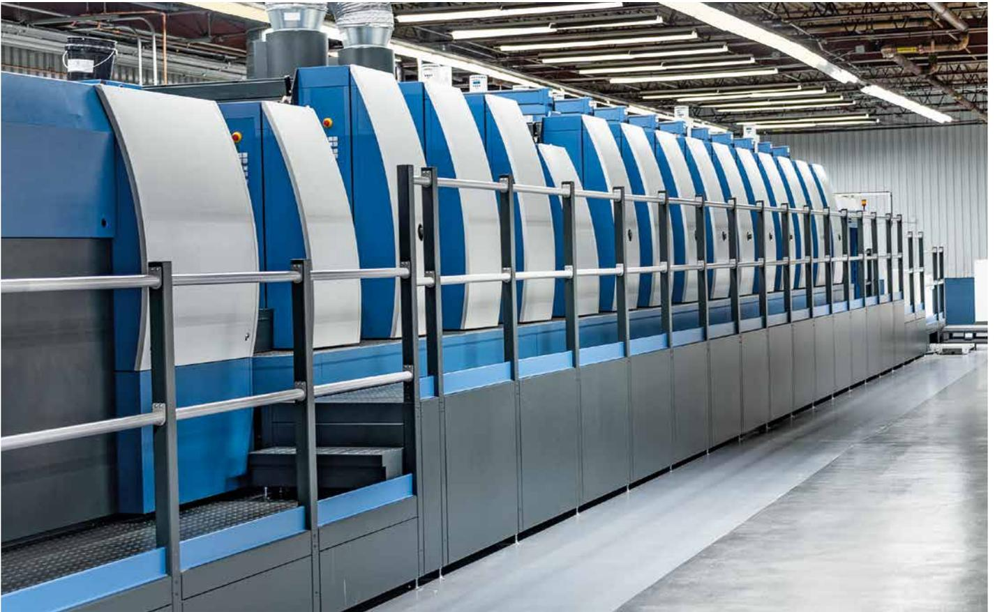
En primavera, Curtis puso en servicio una nueva máquina de doble laca Rapida 106 de once colores con un cuerpo de impresión tras el lacado. Se instaló junto a dos Rapida 130 y sustituye a otra Rapida 130. Con la nueva máquina, sus innovaciones y sus tecnologías avanzadas, se pretenden obtener tasas de crecimiento significativas mediante el uso específico de tecnologías de acabado inline de alta calidad.
