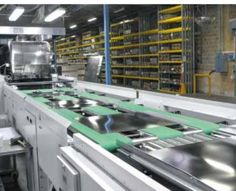
**En el recorrido de conducción de la laca, la laca aplicada tiene tiempo de distribuirse en la hoja, lo que evita estructuras no deseadas**
