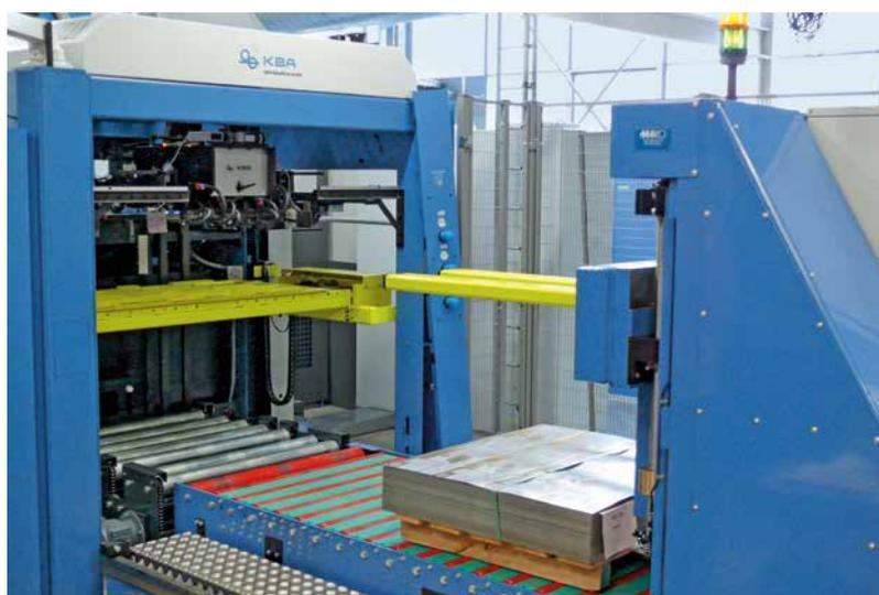
El cambiador automático de palés de la MetalStar 3
