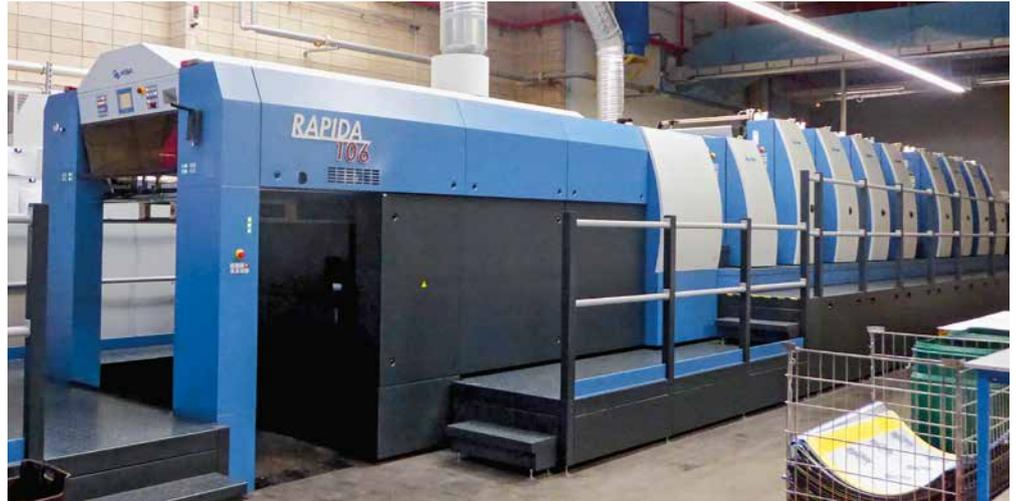
**La Rapida 106 de ocho colores con volteo de pliegos para la impresión 4 sobre 4, torre de laca adicional y equipamiento LED-UV en toda su longitud**
