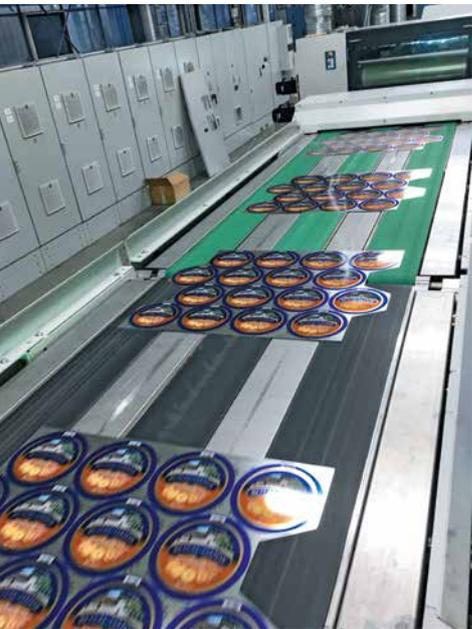
**Économiser les ressources est une priorité absolue dans l'impression sur métal. Des plaques Scroll en cours d'impression et de vernissage. Ces plaques sont estampées pour une utilisation optimale du matériau.**
