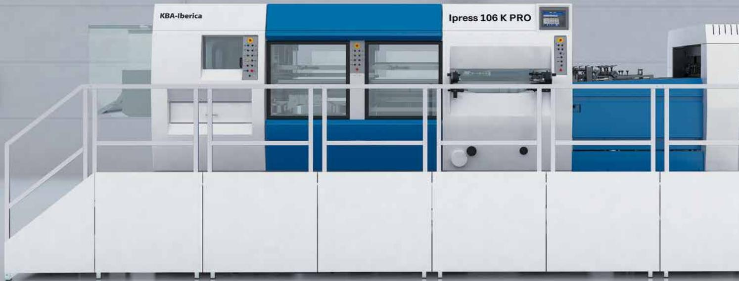
Platine de découpe ultra-automatisée, l'Ipress 106 K PRO est rehaussée de 400 mm en version standard et dotée d'un margeur hérité des presses Rapida.
