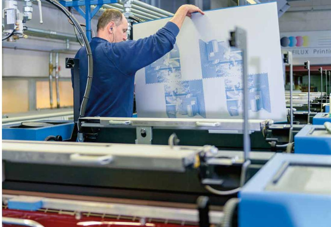
**Arriba: Los cambiadores de planchas (DriveTronic SPC) trabajan con planchas de impresión no encorvadas**
