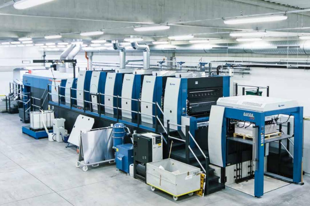
QualiTronic ColorControl Next Generation. Los especialistas de Jílové valoran especialmente la función de medición y regulación del color con QualiTronic ColorControl y QualiTronic PDFCheck (ambos con el mismo sistema de cámaras). QualiTronic PDFCheck compara los pliegos impresos con los PDF de la preimpresión, y detecta las discrepancias en los pliegos impresos comparados. La ventaja de QualiTronic PDFCheck es la evaluación de la calidad de impresión antes de empezar a imprimir la tirada.
