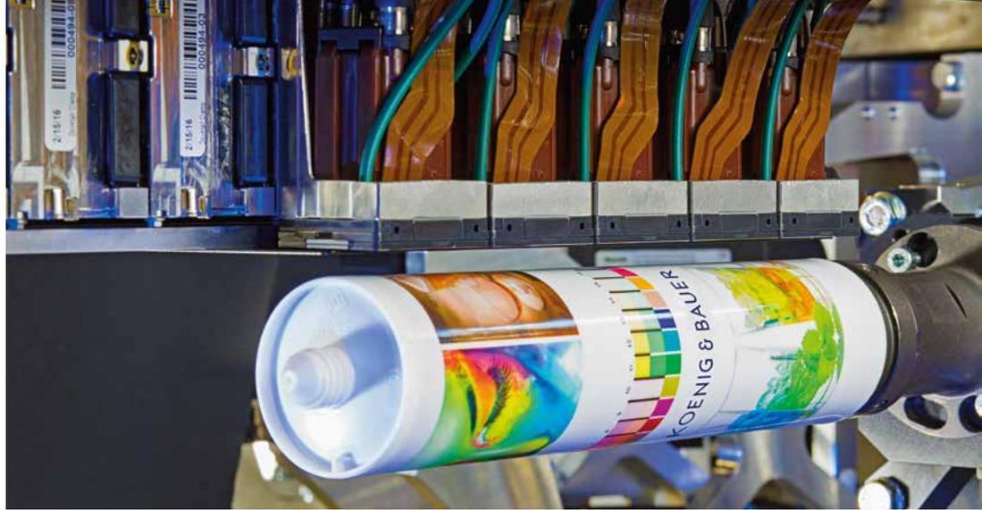
Impresión de inyección de tinta digital en un cartucho de lubricante
