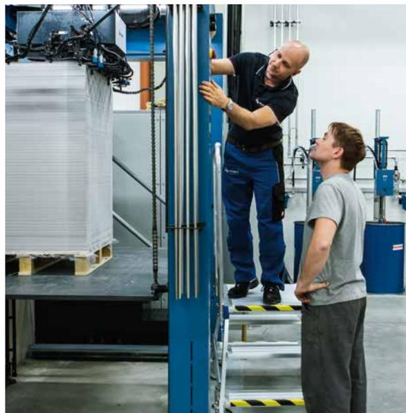
**La Rapida 164 está elevada para la producción de cartonajes. La altura de pila posible se puede ver especialmente bien en el marcador**
