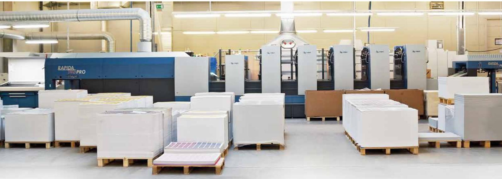
El corazón de la sala de impresión: la nueva Rapida 105 PRO de cinco colores con torre de laca y prolongación de la salida
