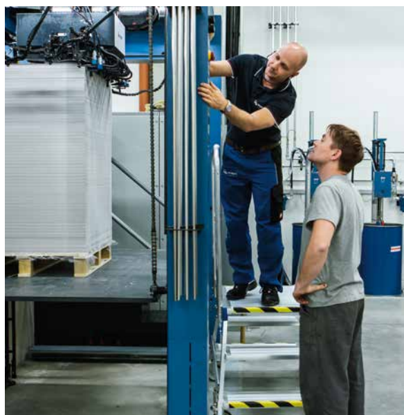
La Rapida 164 est rehaussée pour les cartonnages. La hauteur de pile possible est bien visible au niveau du margeur.
