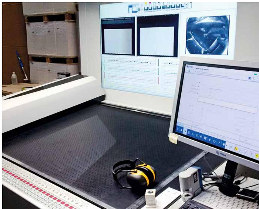
Check o QualiTronic PrintCheck. Mediante inyección de tinta, se coloca un número consecutivo en los pliegos que entran en la Rápida. QualiTronic PDFCheck o QualiTronic PDF HighRes detectan los pliegos erróneos, los asocian al número de identificación y los marcan en el protocolo de pila, para después retirarlos manualmente.
