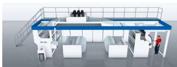
de fijación. El grupo de aplicación con raqueta de cámara puede operar, en función del producto, directa o indirectamente con la lámina. A continuación, a través de un rodillo llamador de aspiración, la lámina pasa por el secador continuo posterior (solo necesario si se usan lacas con disolvente) y por una batería de rodillos al rodillo de regulación térmica de la instalación Excimer y UV de IOT-Leipzig. Allí se realiza el recubrimiento mate de la lámina. A continuación, la lámina se enrolla.
