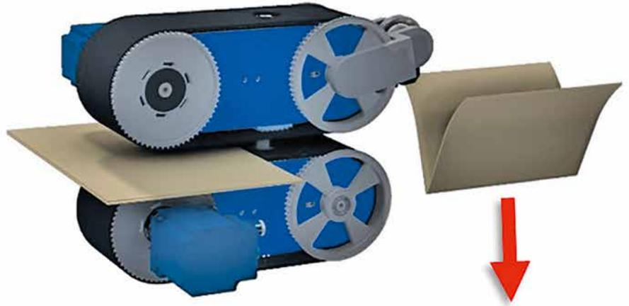
KF 80 se adaptó con un módulo de tercer plegado posterior de Koenig & Bauer y se implementó una grapadora lateral.
