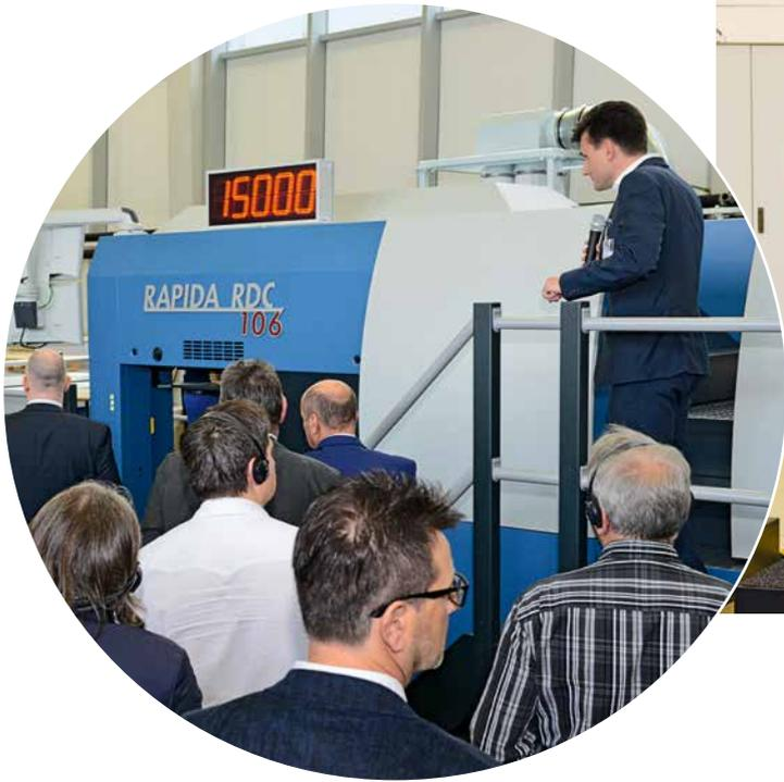
**Arriba: Cambio radical: en la troqueladora rotativa Rapida RDC 106 se troquelaron y arrancaron cajas plegables con una velocidad de 13.000 pl./h. Tras un rápido cambio de las herramientas de troquelado, se procedió al pretroquelado de etiquetas adhesivas con 15.000 pl./h**
