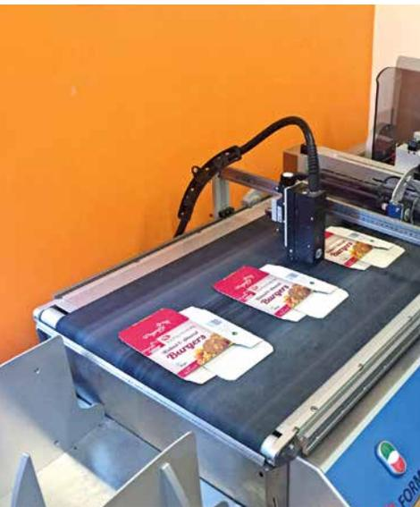
**Para lograr un mayor rendimiento y menos errores en la datación de los productos, Dragonfly utiliza con éxito el sistema de marcación offline udaFORMAXX con una impresora de chorro de tinta alphaJET**
