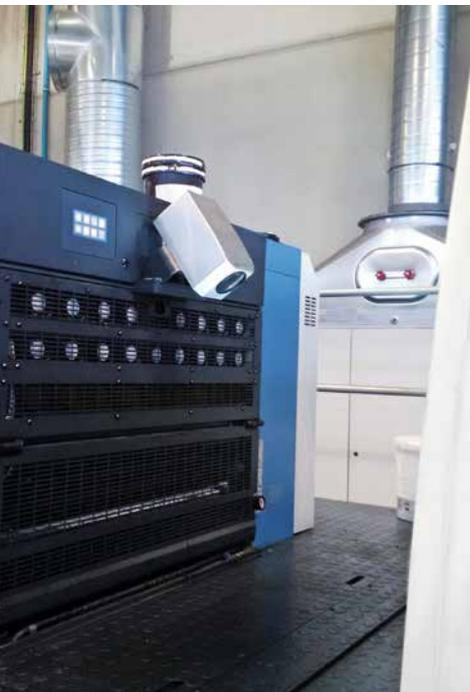
El alcance funcional del control del registro inline no varía: la medición y regulación del registro se realizan a través del probado QualiTronic ICR, que se continúa pudiendo utilizar independientemente de QualiTronic 2.
