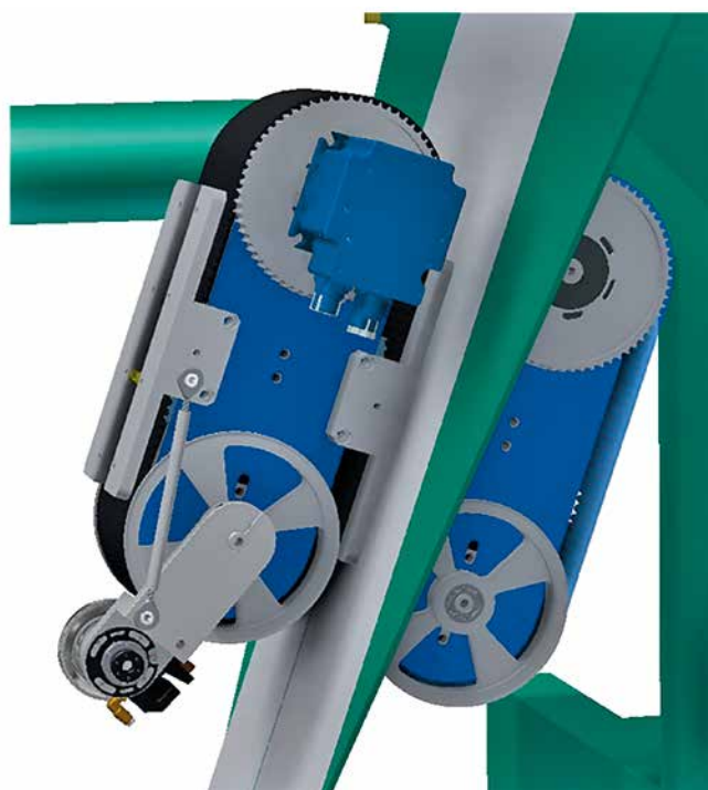
Cucitrice laterale per la cucitura in formato broadsheet sul cono
