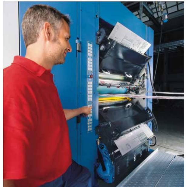
La KBA C16, ampiamente automatizzata per un rapido cambio degli ordini, è anche dotata di un modulo interessante per la finitura in linea, ossia il gruppo di verniciatura UV
