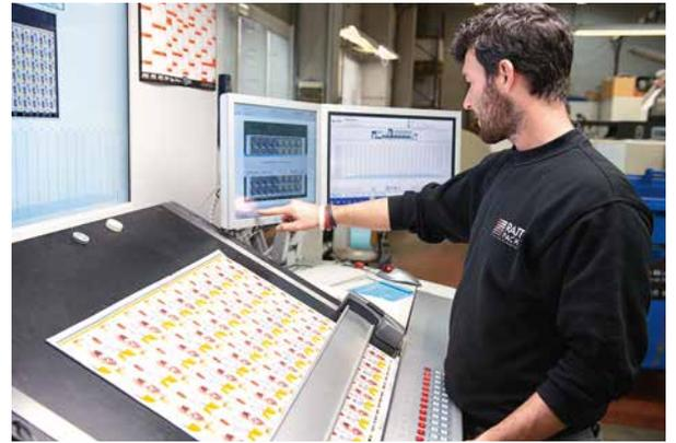
Sinistra in alto: la Rapida 75 PRO è dotata di un pulpito di comando ErgoTronic con tecnologia TouchTronic e wallscreen
