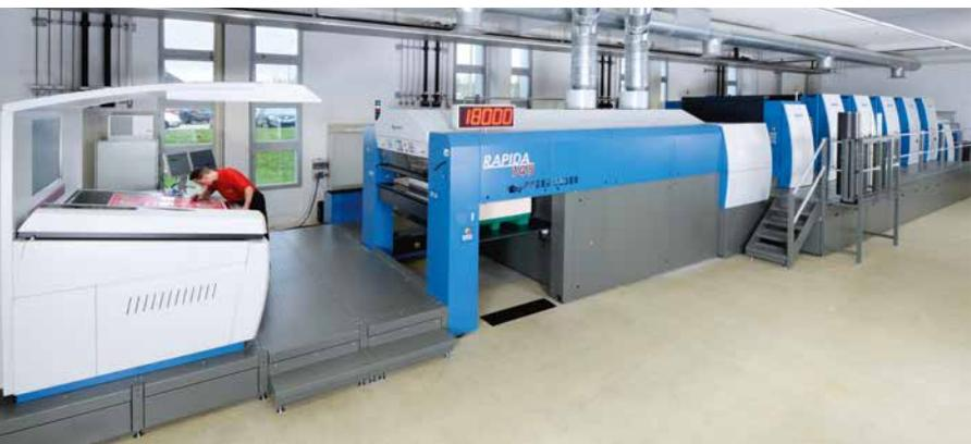
Rapida 145 con cambio delle lastre simultaneo DriveTronic SPC e DriveTronic Plate Ident
