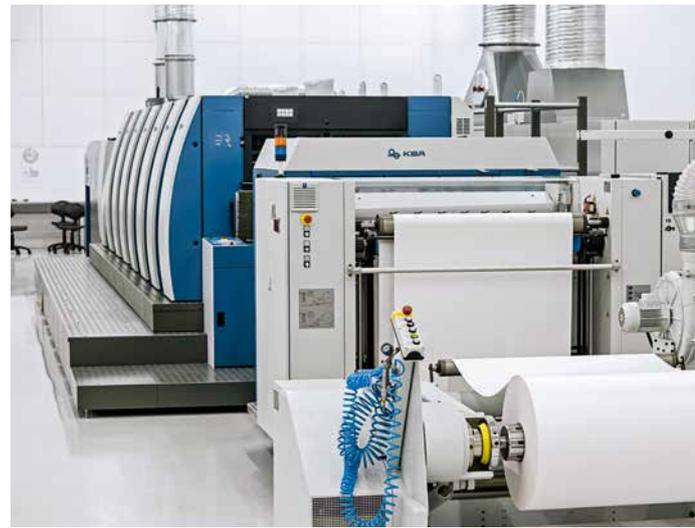
Oltre al taglio del materiale in bobina, il tagliafogli da bobina RS 106 svolge tutta una serie di funzioni per la preparazione delle pellicole in PP
