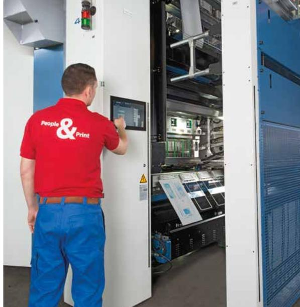
Grazie al cambialastre completamente automatico della Commander CL di Münster è possibile cambiare gli ordini delle numerose testate locali in soli cinque minuti
