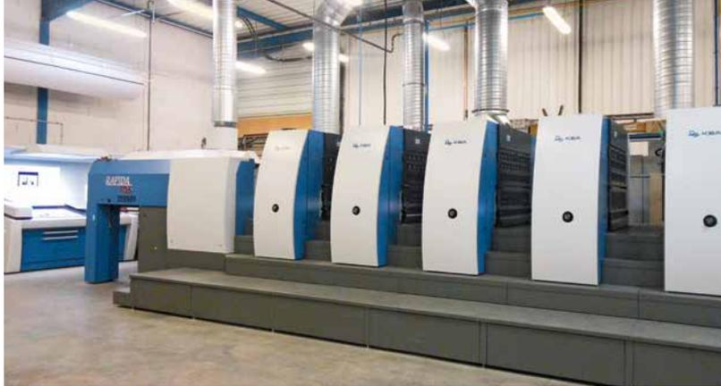
La nouvelle Rapida 106 cinq couleurs HR-UV avec système de contrôle couleur embarqué QualiTronic ColorControl, changement de plaques automatique et le nouveau pupitre TouchTronic.
