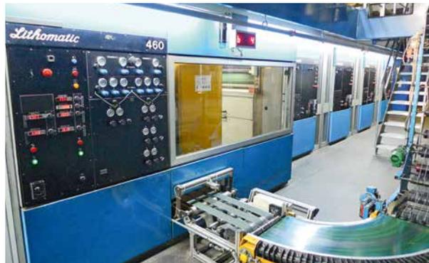
les anciennes machines sont à double développement mais ne fonctionnent pas en accumulation. Chaque plaque doit par conséquent être fabriquée et calée en double. Pour raccourcir les déplacements des opérateurs et accélérer le changement de plaque semi-automatique, des postes de tri des plaques desservis par un élévateur ont été installés sur les niveaux supérieurs des deux Commander CL.
