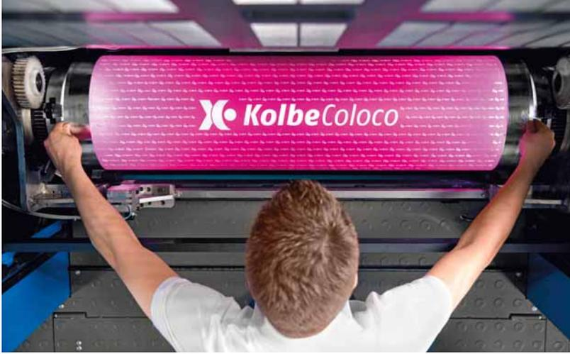
ne con rivestimento speciale comprimibile ed un rullo cromato commutabile. Il sistema racla aggiuntivo, completamente automatico e con aspirazione integrata, rimuove i corpi estranei dal rullo cromato e li aspira. Grazie alla regolazione di precisione della pressione di stampa, il gruppo calandra si adatta perfettamente al substrato in lavorazione.
