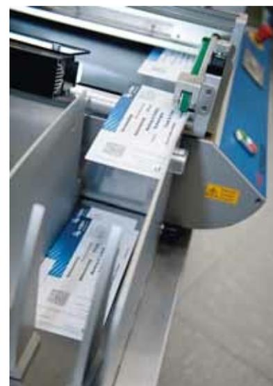
rateurs peuvent remplir le chargeur en cours de production et assurer ainsi un fonctionnement ininterrompu avec une vitesse de marquage élevée.
