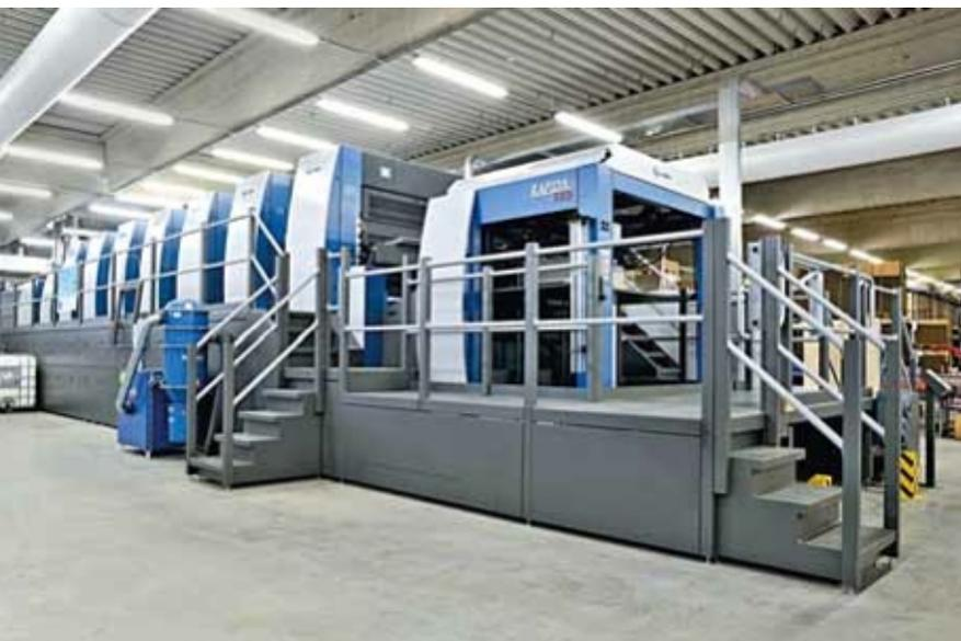
La machine est rehaussée de 630 mm et configurée précisément pour répondre aux spécificités de l'impression d'emballages.
