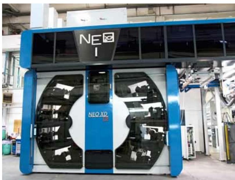
**La nouvelle NEO XD LR est conçue pour tous les systèmes d'encres utilisés aujourd'hui en impression flexo à tambour central et imprimera des films plastique avec des encres à l'eau.**
