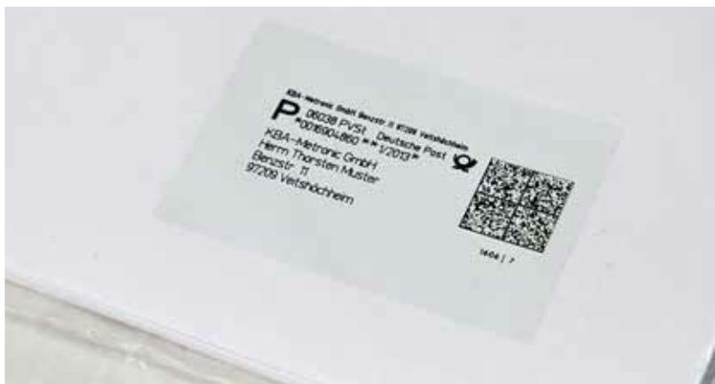
**Après la mise sous pli, l'adresse est gravée au laser à travers le film sur le champ sensible au laser.**
