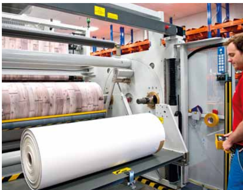
Las bobinas impresas en la rebobinadora se retiran con la producción en marcha
