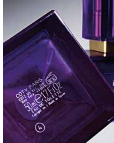
Dcha.: Marcación compatible con el diseño de envases cosméticos mediante la serie ablative laserSYSTEM de KBA-Metronic
