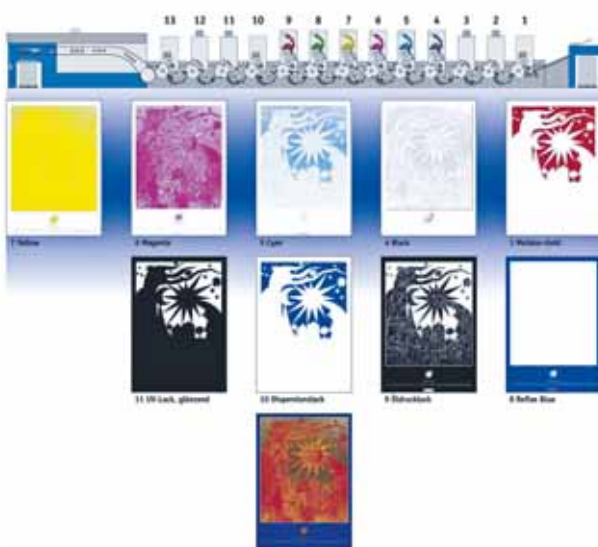
Fig. 3: Adecuada para laca Metalur con posterior acabado híbrido: Rapida 105 LTT+6+LTTTL con doble prolongación de la salida y representación de las separaciones de tinta y laca con el ejemplo del calendario de KBA de 2007
