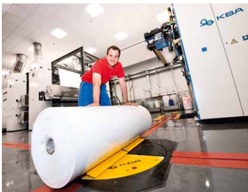
La alimentación del cambiador de bobinas de KBA con las bobinas de papel de 1,68 m de ancho se realiza manualmente con KBA Patras M
