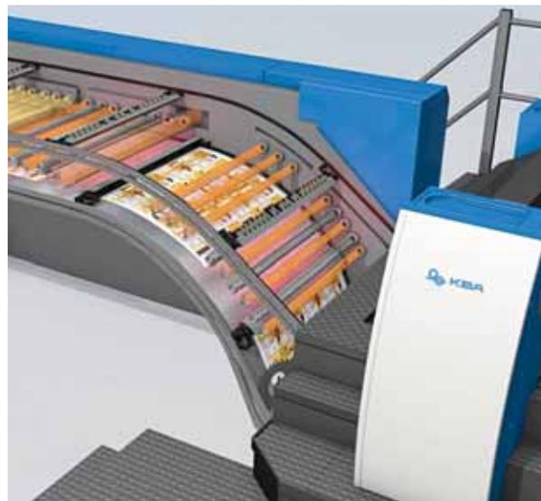
**Nell'essiccazione è stato fatto molto in termini di efficienza energetica. Qui la rappresentazione schematica dei sistemi di essiccazione VariDry<sup>BLUE</sup> nel prolungamento dell'uscita della Rapida 106**
