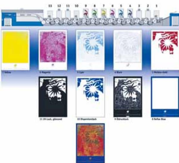
Fig. 3: idonea alle vernici metalliche Metalur con successiva finitura ibrida: Rapida 105 LTT+6+LTTL con doppio prolungamento dell'uscita e rappresentazione delle separazioni di colore e vernice sull'esempio dell'agenda KBA 2007
