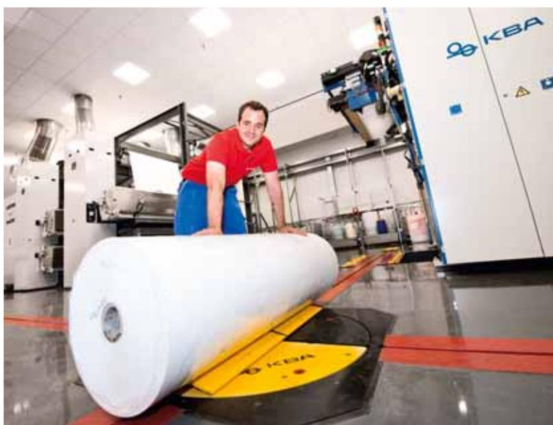
L'alimentazione del cambiabobine KBA con bobine di carta di 1,68 metri di larghezza avviene manualmente con il KBA Patras M
