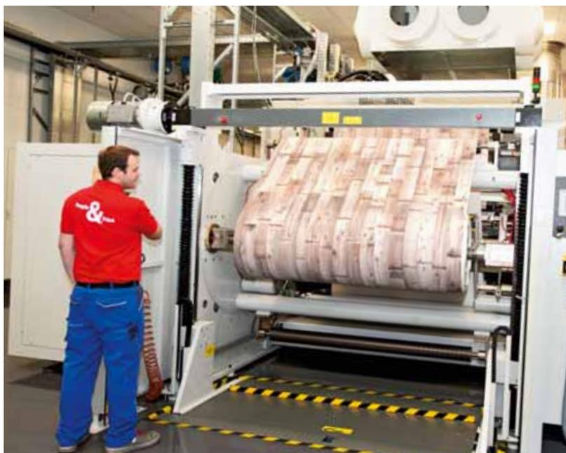
**Oben:** Der automatische Papierbahneinzug ist eine der Stärken der KBA RotaJET für den industriellen Druck
