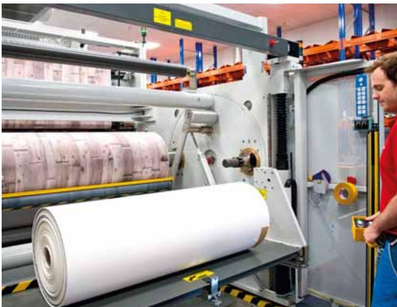
Die bedruckten Rollen am Rewinder werden bei laufender Produktion entnommen
