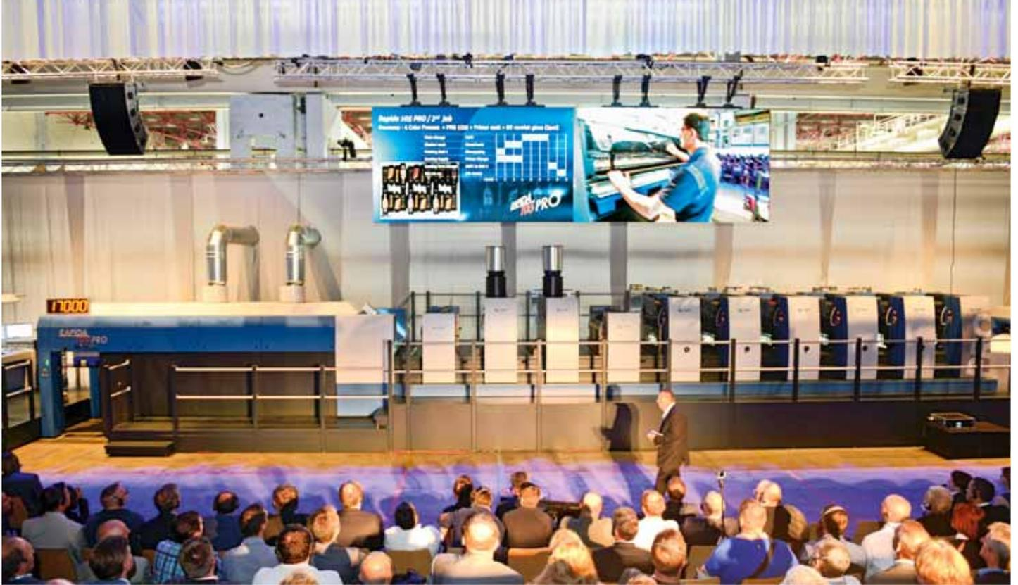
Lackplattenwechsel mit DriveTronic SFC gezeigt. Auf einer Fünffarben-Rapida 75 der neuesten Generation mit Lackturm und LED-Trockner liefen diverse Druckjobs fürs schnelle Umschlagen. Zu den Schwerpunkten der Präsentation gehörte die mit LED-UV mögliche brillantere Druckqualität auf Offsetpapier.
