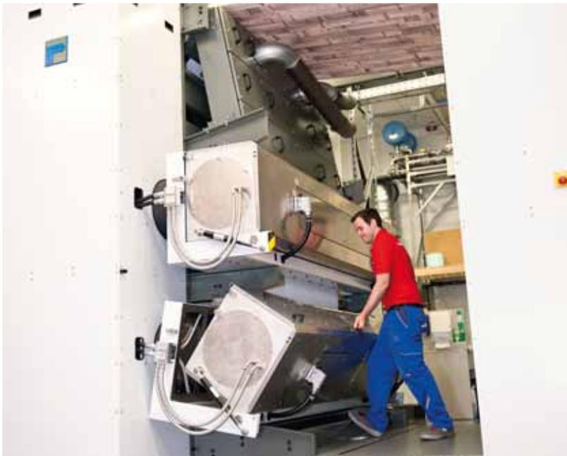
Zwei abschwenkbare Hybrid-Trockner (IR-/Warmluft) nach dem Druck
