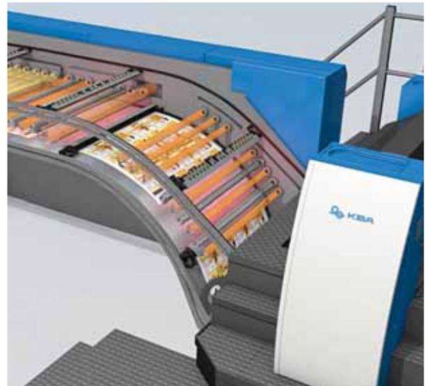
Bei der Trocknung hat sich besonders viel in Sachen Energieeffizienz getan. Hier die schematische Darstellung des VariDry<sup>BLUE</sup>-Trocknungssystems in der Auslageverlängerung der Rapida 106
