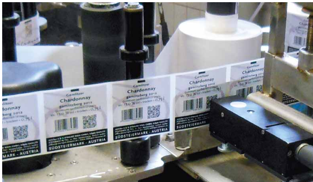
Marcación de superficies abovedadas con alphaJET into
