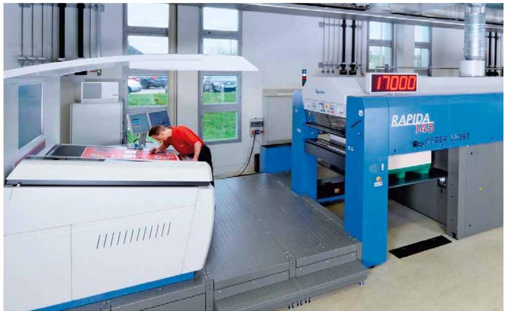
I moduli di automazione ripresi dalla Rapida 106, ad esempio l'alimentazione senza squadra SIS o il cambio simultaneo delle lastre con il DriveTronic SPC, hanno ridotto enormemente i tempi di cambio degli ordini sulla Rapida 145 da 17.000 fogli/h, rendendo quindi il formato grande alquanto interessante anche per le tirature più piccole
