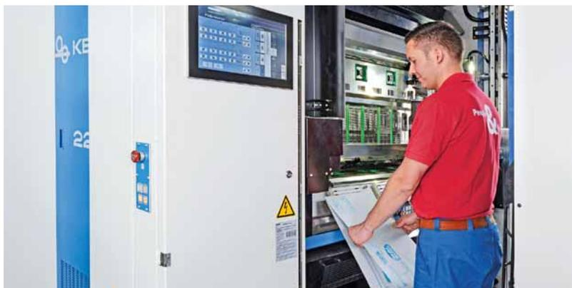
Il cambialastre completamente automatico consente di cambiare rapidamente tiratura nella produzione di giornali di Landshut già da tempo orientata ai gruppi target
