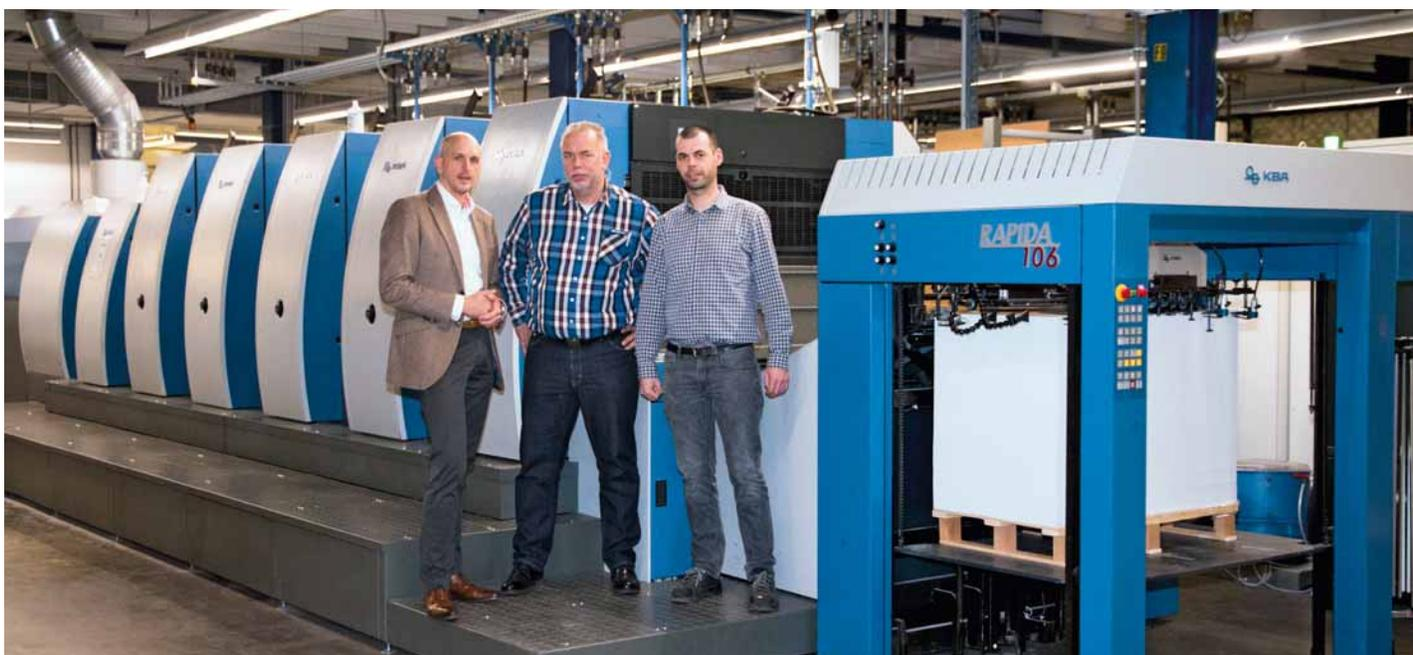
minuti, anche grazie al sistema di cambio automatico delle lastre FAPC. Con ordini dello stesso tipo andiamo in tiratura di stampa in media dopo 40, 70 fogli. Qui ci assiste l'alimentazione senza squadra SIS. La sicurezza e la qualità della tiratura sono assicurate dalla messa a registro in linea QualiTronic ICR. Inoltre, con l'essiccatoio VariDryBLUE, risparmiamo circa il 35, 40% di energia.
