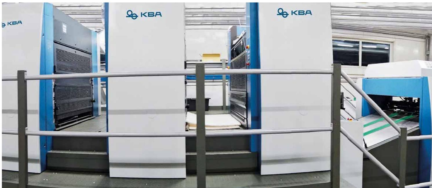
La Rapida 164 installée à Czluchów est l'une des premières presses en Pologne au format étendu 120 x 164 cm. Équipée d'un module CX, elle peut passer du carton jusqu'à une épaisseur de 1,2 mm et de l'ondulé jusqu'à 1,6 mm d'épaisseur. Pour un meilleur rendement avec des supports aussi épais, elle a été rehaussée de 420 mm. Le contrôle de la qualité est effectué par ErgoTronic ColorControl avec la fonction ErgoTronic Lab pour la mesure et la régulation de l'encre suivant les valeurs Lab.
