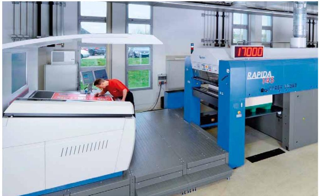
Des modules d'automatisation hérités de la Rapida 106, comme la marge SIS sans guide latéral ou le changement simultané des plaques d'impression avec DriveTronic SPC ont considérablement réduit la durée du changement de travail sur la Rapida 145 qui roule jusqu'à 17 000 feuilles/h, rendant ainsi le grand format intéressant pour de plus petits tirages.
