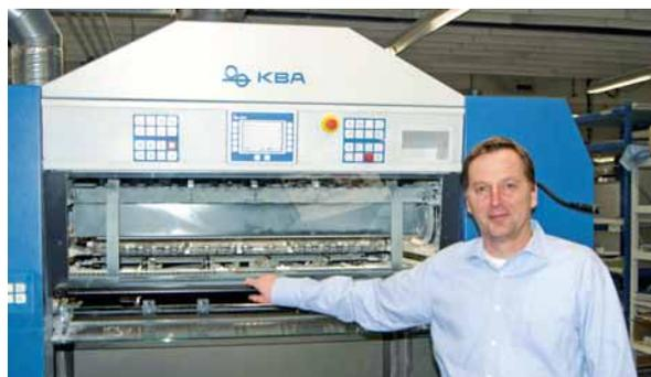
IR/TL KBA VariDry<sup>BLUE</sup> dans la rallonge et en sortie, aspiration de la poudre, laveurs CleanTronic et réduction de l'alcool isopropylique à moins de 5 %.
