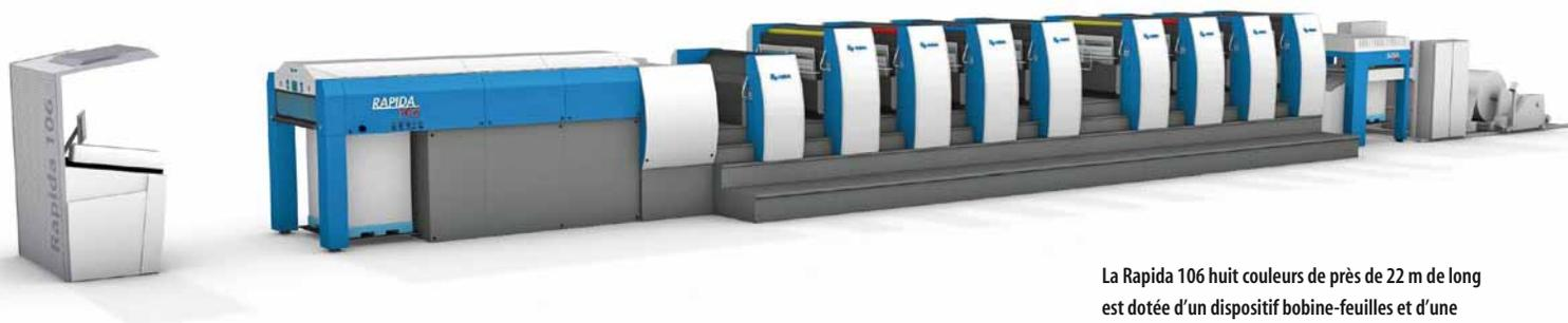
La Rapida 106 huit couleurs de près de 22 m de long est dotée d'un dispositif bobine-feuilles et d'une technologie de séchage LED de pointe.
