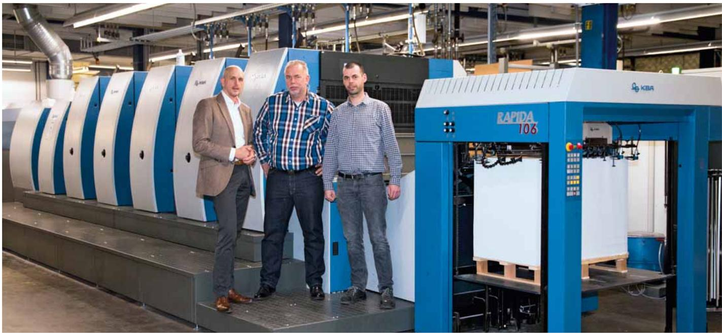
feuilles suffisent pour lancer le tirage. Ceci également grâce à la marge sans guide latéral SIS. La fiabilité et la qualité du tirage sont assurées par la mesure du registre en ligne QualiTronic ICR. De plus nous économisons grâce au sécheur VariDry<sup>BLUE</sup> entre 35 et 40 % d'énergie.
