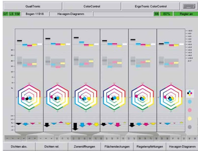
Ausgleich zwischen Tonwertzunahme, Spreizung, Vollton- $L^*a^*b^*$ -Zielwert und der dazugehörigen Dichte vorgenommen. Diese wird über eine «Best Match»-Funktion automatisch innerhalb einer bestimmten Toleranz angepasst. Die Farbkorrektur wird mit QualiTronic ColorControl automatisch (closed loop) bzw. bei ErgoTronic ColorControl und ErgoTronic ColorDrive per Tastendruck ausgeführt.
