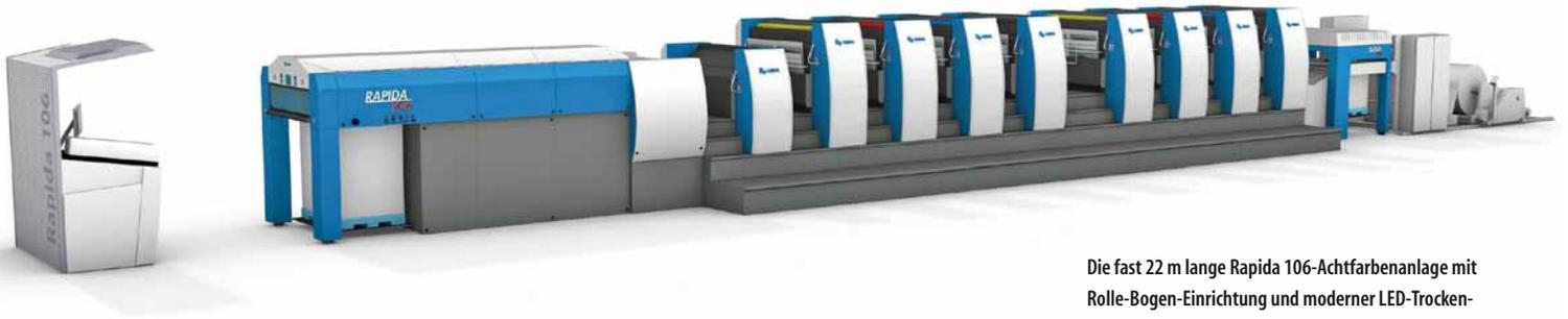
Die fast 22 m lange Rapida 106-Achtfarbenanlage mit Rolle-Bogen-Einrichtung und moderner LED-Trockentechnologie
