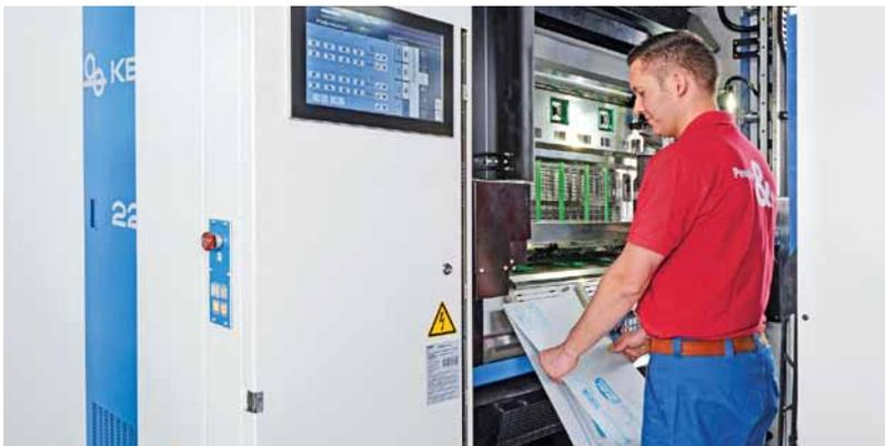
Der Plattenwechselvollautomat ermöglicht einen schnellen Auflagenwechsel bei der in Landshut schon länger praktizierten zielgruppenorientierten Zeitungsproduktion
