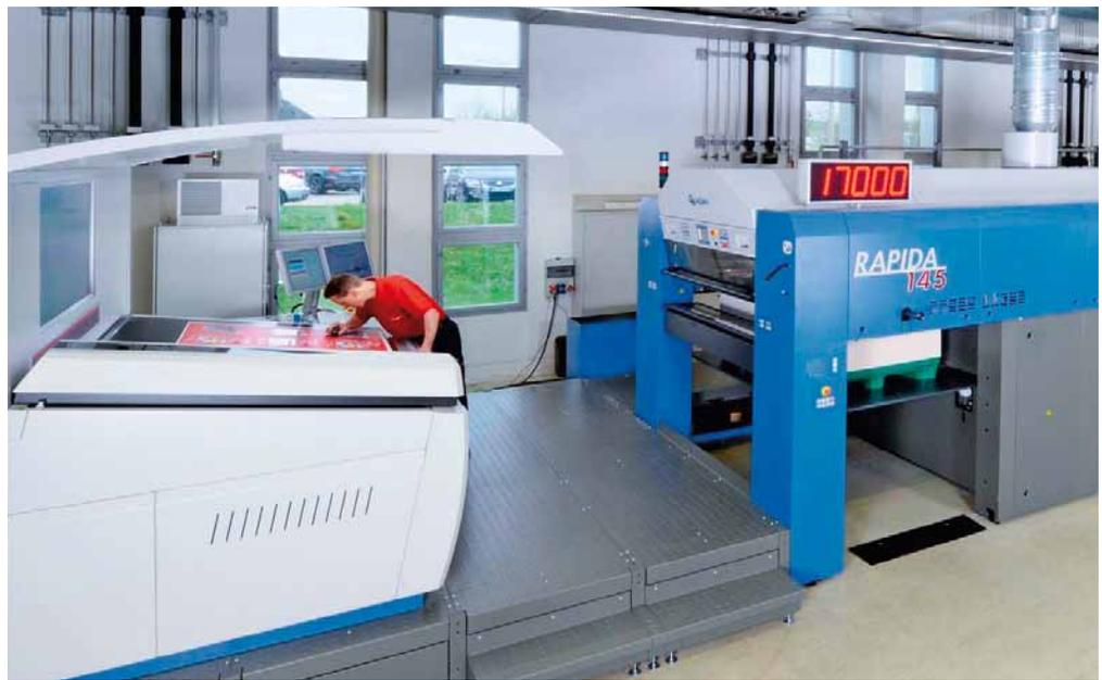
Von der Rapida 106 übernommene Automatisierungsbausteine, z. B. die ziehmarkenfreie SIS-Anlage oder der simultane Druckplattenwechsel mit DriveTronic SPC, haben die Zeit für den Jobwechsel an der bis zu 17.000 Bogen/h schnellen Rapida 145 stark verkürzt und so das Großformat auch für kleinere Auflagen interessant gemacht
