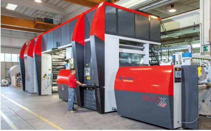
Izda.: La serie EVO XG está pensada para anchos de impresión más grandes de hasta 2 m y velocidades elevadas de hasta 600 m/min
