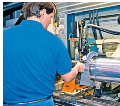
Estrecha colaboración con la matriz KBA en Würzburg: medir, cambiar y rectificar los aros de carga
