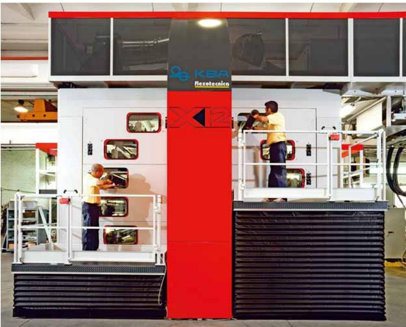
Cambio de sleeve en la instalación de alta tecnología EVO XG 12
