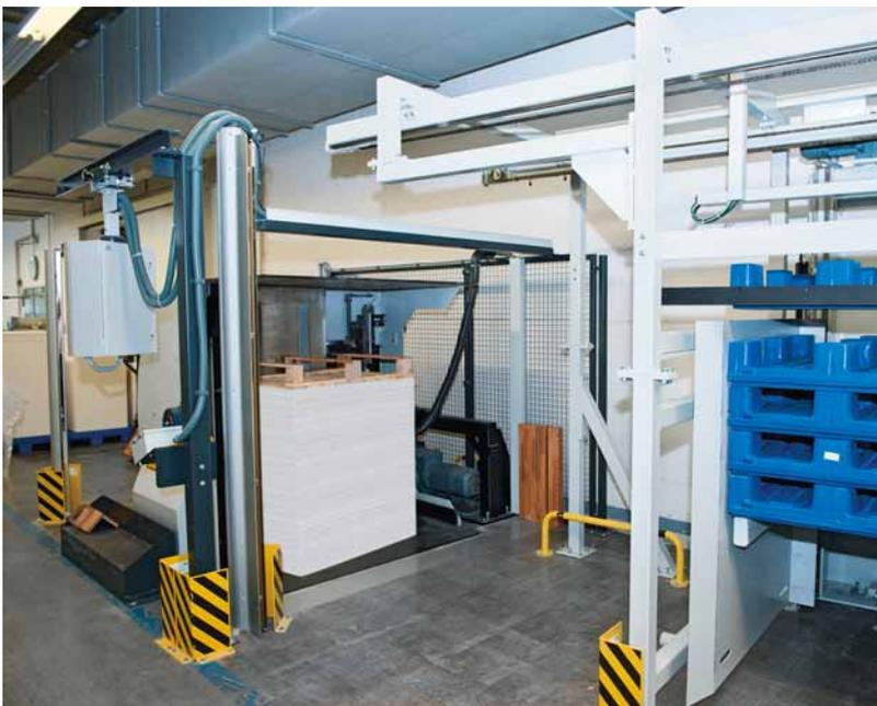
**Un volteador de pilas semiautomático pone las pilas exactamente en palés nonstop**
