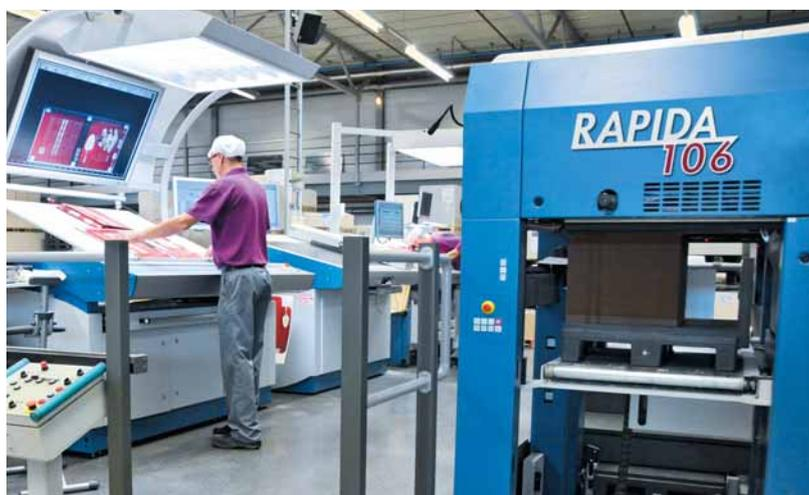
**Logistica dei bancali automatizzata sull'uscita:** i bancali per la pila successiva vengono trasportati dal mettifoglio all'uscita da sotto la piattaforma della macchina
