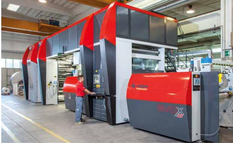
Sinistra: la serie EVO XG è destinata a larghezze di stampa fino a 2 metri e velocità elevate fino a 600 m/min.
