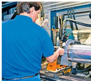
Stretta collaborazione con la casa madre KBA di Würzburg: misurazione, sostituzione e rettifica delle corone di controllo
