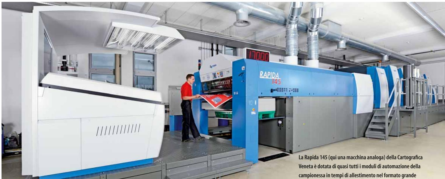
La Rapida 145 (qui una macchina analogica) della Cartografica Veneta è dotata di quasi tutti i moduli di automazione della campionessa in tempi di allestimento nel formato grande
