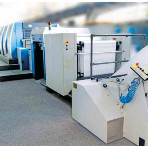
Con la Rapida 106-8-SW4 con el marcador de bobinas a pliegos RS 106, se pueden procesar más rápidamente los pedidos que con el marcador de pliegos habitual
