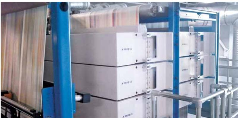
**Einer der drei Drucktürme ist mit einer Prime UV-Einrichtung für akzidenznahe Produkte ausgestattet**
