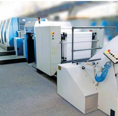
Mit der Rapida 106-8-SW4 mit dem Rolle-Bogen-Anleger RS 106 können Aufträge schneller abgewickelt werden als mit dem üblichen Bogen-Anleger
