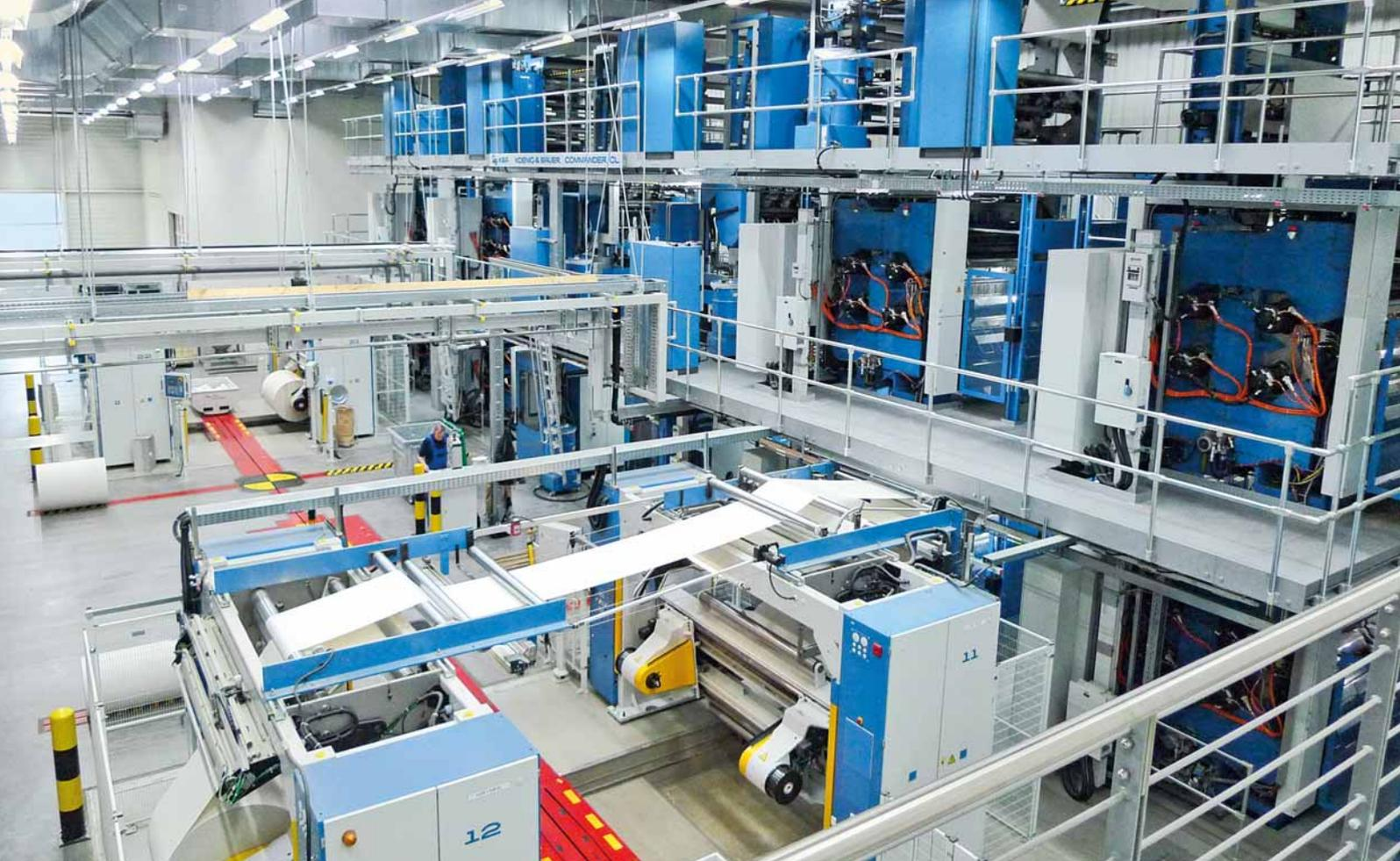
Ungewöhnliches Maschinenlayout: Die KBA Commander CL ist eine Parterre-Maschine mit um 90 Grad versetzt platzierten Rollenwechslern
