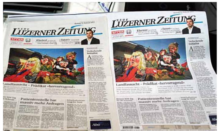
Con motivo de los “Hunkeler Innovationdays” en febrero de 2013, la KBA RotaJET imprimió cada mañana de manera fiable la *Luzerner Zeitung* a partir de los datos en PDF originales con buena calidad. La foto derecha muestra a la izquierda el original impreso en offset y, a la derecha, la edición impresa de forma digital
