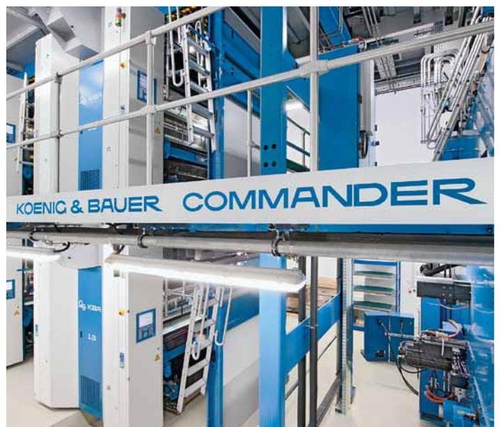
El diseño modular de la KBA Commander CL permite un equipamiento individual y una actualización posterior si cambian los requisitos de producción
