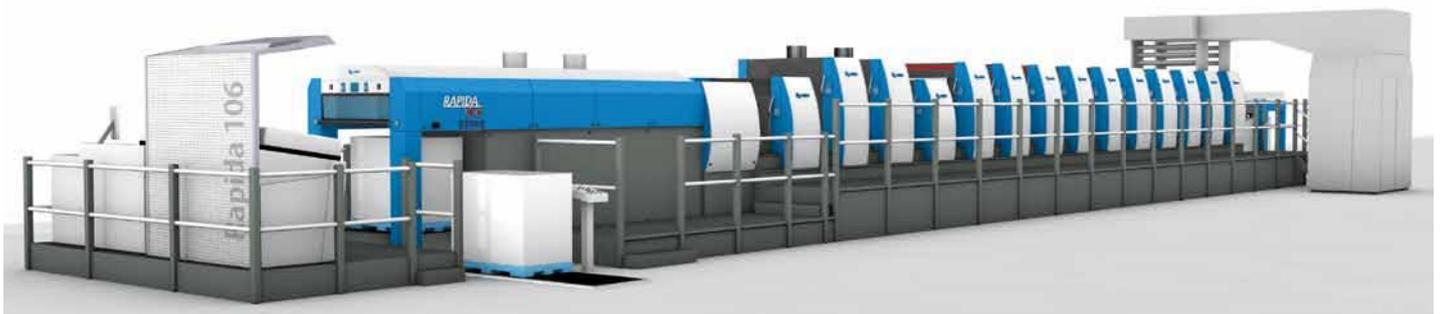
La Rapida 106 con diez sistemas de entintado, tecnología de doble laca y acabado de láminas en frío pronto proporcionará efectos brillantes en la impresión de envases en la imprenta Yuri Gagarin de Plovdiv (Bulgaria)
