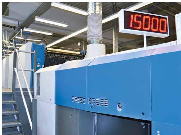
Con hasta 15.000 pl./h en impresión 4 sobre 4, la Rapida larga de formato grande alcanza el rendimiento de las máquinas modernas de formato medio
