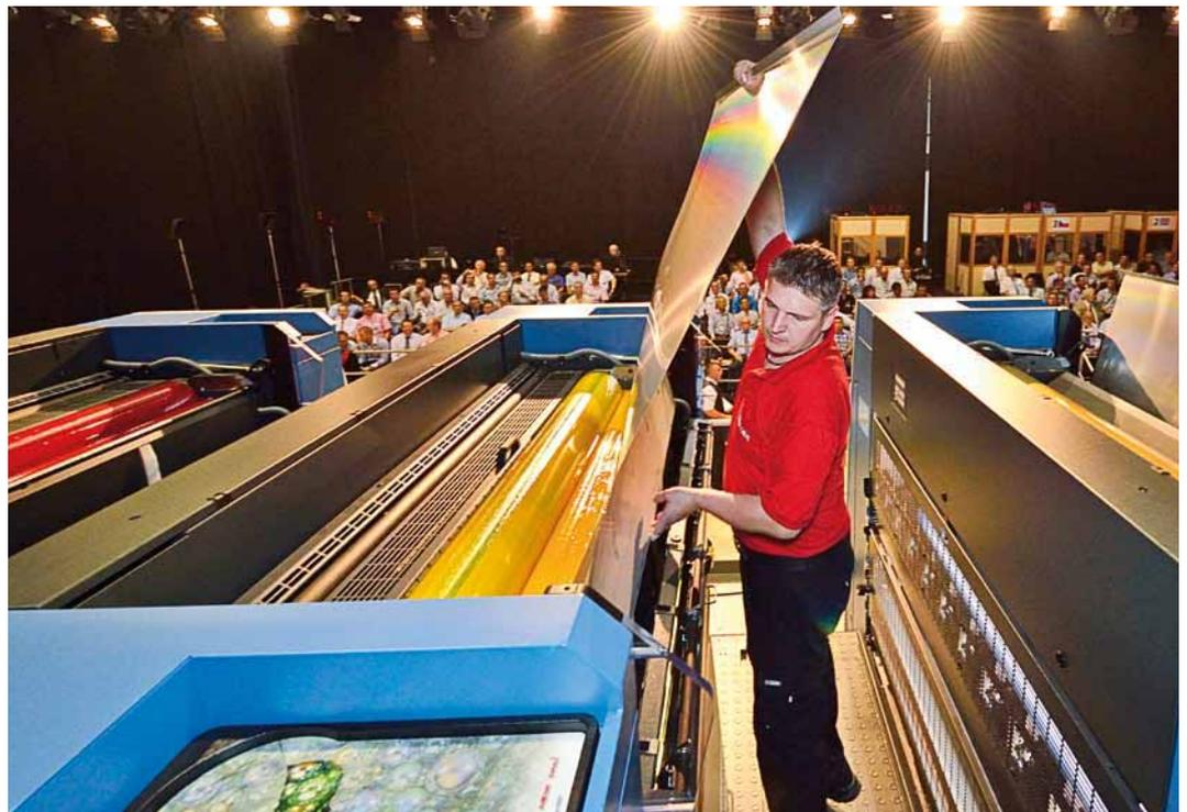
Debido a los cambios de trabajo rápidos y frecuentes con DriveTronic SPC, Hendrik Gasch apenas daba abasto alimentando los compartimentos de cambio con planchas
