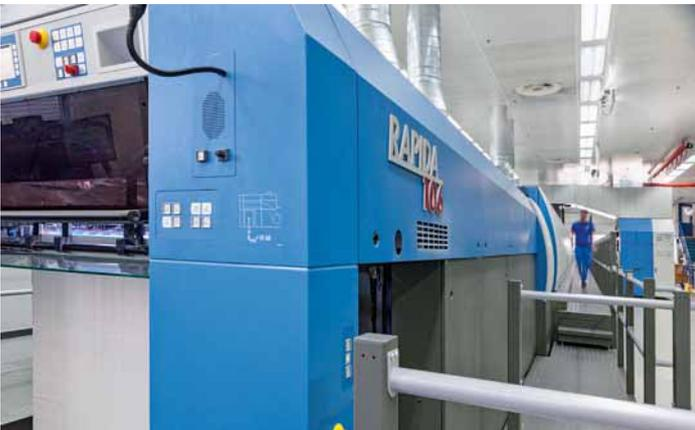
Con esta longitud de máquina se acumulan algunos metros que los impresores deben recorrer en cada turno entre el marcador y la salida. Al fondo también puede verse el módulo de láminas en frío
