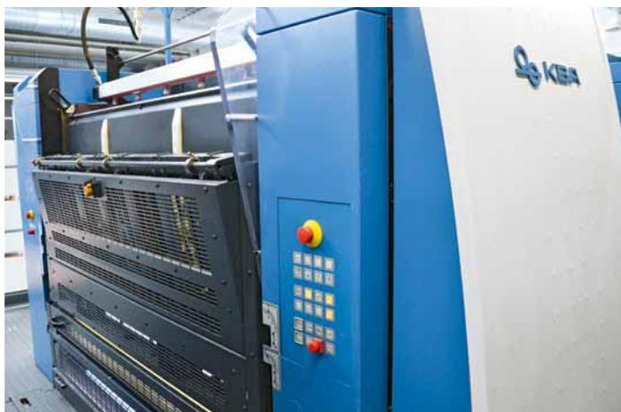
**Campeona mundial en tiempos de preparación en formato grande: gracias a la técnica de accionamientos individuales DriveTronic SPC, todas las planchas de los ocho cuerpos de impresión se pueden cambiar simultáneamente en 1:40 min. El lavado paralelo con CleanTronic Synchro contribuye a los breves tiempos de preparación**
