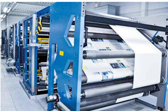
La superestructura de la rotativa está equipada con múltiples equipos de volteo y cabezales de encolado para una variedad máxima de productos
