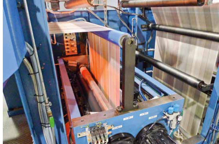
Vista dall'alto del gruppo di verniciatura doppia direttamente sopra la torre di stampa Cortina per entrambi i lati del nastro
