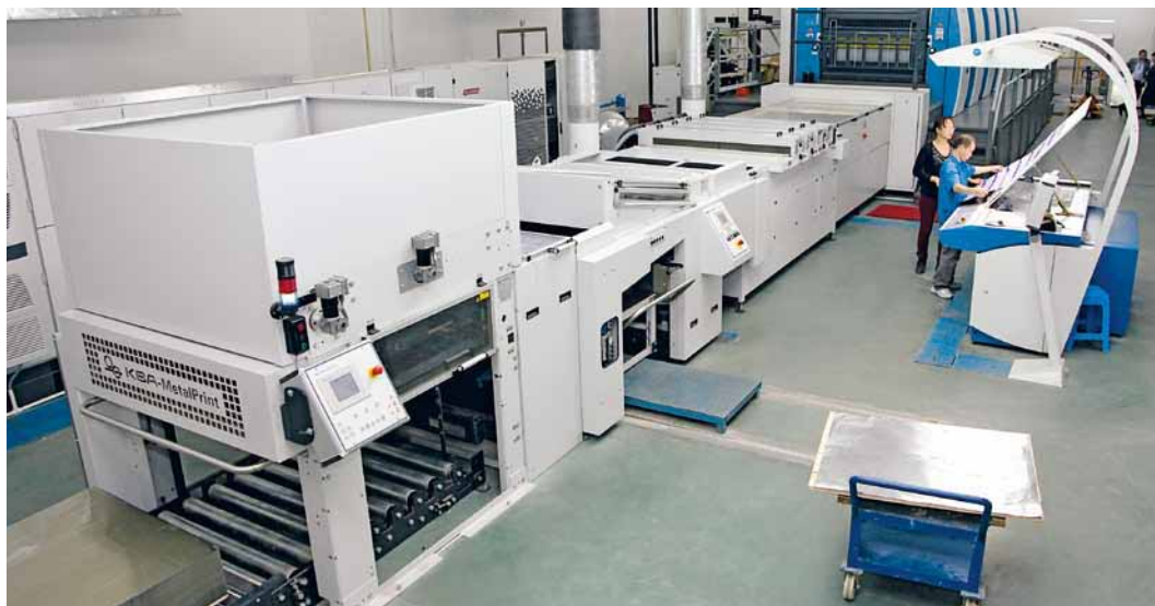
La foto mostra la linea installata già nel 2012: una MetalStar PR a sei colori UV con SMS e impilatore ad alta velocità
