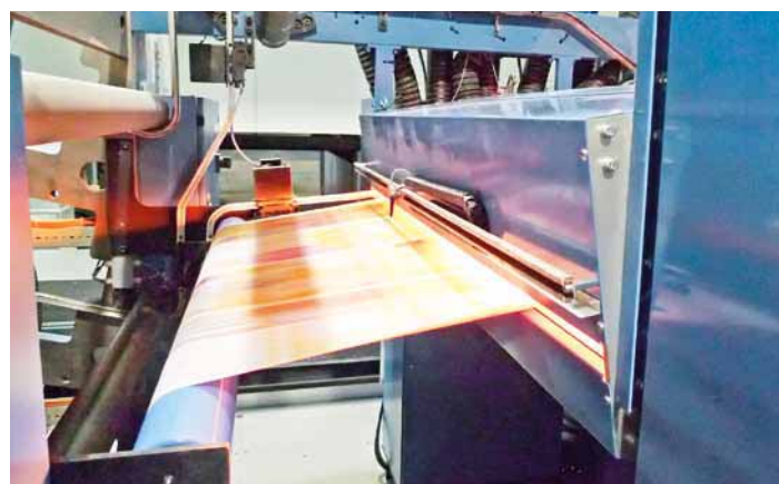
Con l'essiccatoio IR/TL di un solo metro di lunghezza di Eltosch, la verniciatura è possibile su quasi tutti i tipi di carta migliorata
