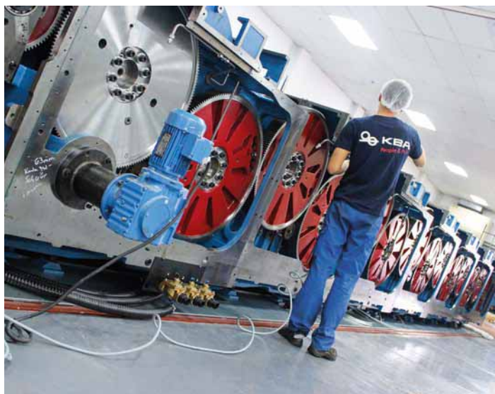
Terminato l'assemblaggio dei box sottostruttura ha inizio l'installazione dei gruppi di stampa
