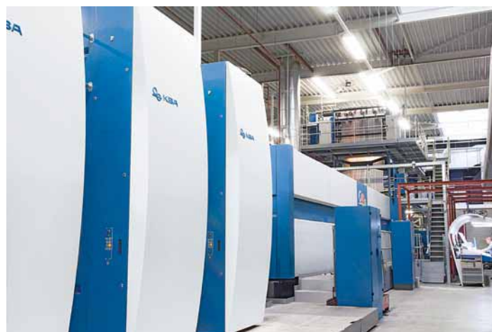
La KBA C56 SG con una larghezza massima del nastro di 2.280 mm è finora l'unica rotativa sul mercato per 56 pagine oblunghe
