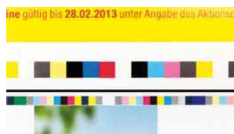
Set di campi di misura per l'Instrument Flight della Rapida (in alto, adesso anche 3 x 3 mm), strisce System Brunner per il QuadTech CCS nell'heatset (in basso)
