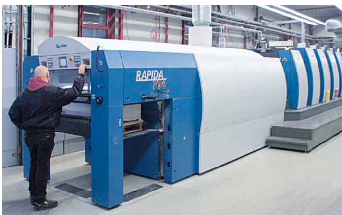
La KBA Rapida 106 installata nel 2011 è dotata del sistema di misura e regolazione dell'inchiostro KBA QualiTronic Color Control plus System Brunner Instrument Flight
