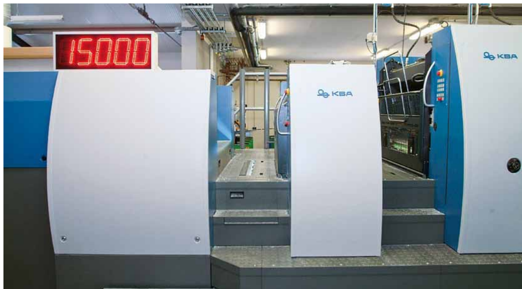
15.000 fogli/h sono la velocità di produzione standard con cui lavora Lönneker. Anche se la macchina può raggiungere velocità superiori non avrebbe molto senso sfruttarle, vista la preponderanza di piccole tirature
