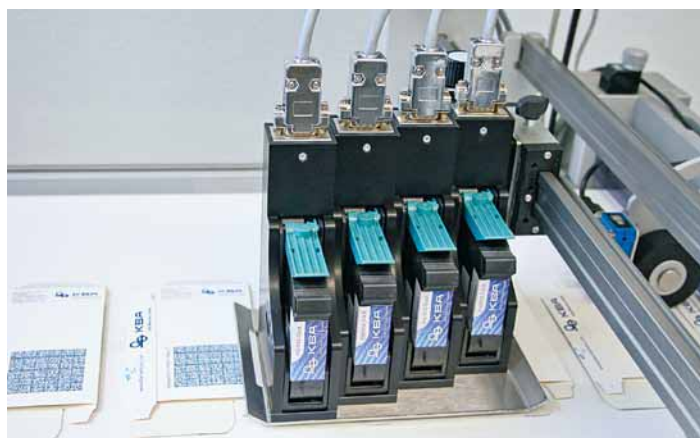
Fino a quattro testine di stampa posizionabili in cascata, ossia larghezze di stampa fino a 2" (50,8 mm)
