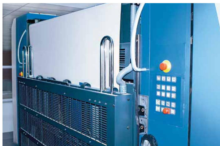
I cambialastre completamente automatici FAPC permettono un rapido cambio degli ordini
