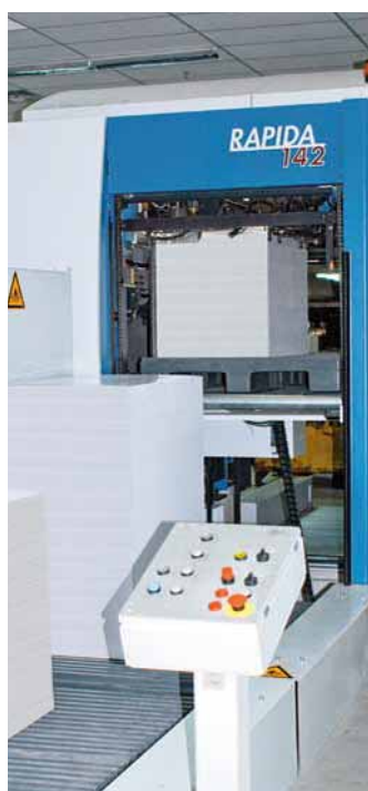
Una particolarità della Rapida 142 alla TWP è la logistica di impilaggio completamente automatica, qui sul mettfoglio
