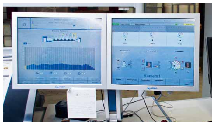
Sui due schermi touch sono attivi a destra il navigatore Instrument Flight Balance Navigator con i suoi diagrammi a spazi cromatici esagonali e, a sinistra, la posizione dei cursori inchiostro con l'indicazione per il lavaggio del caucciù
