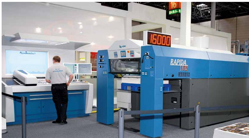
Il modernissimo pulpito di comando ErgoTronic della Rapida 105 con sistema di misurazione integrato
