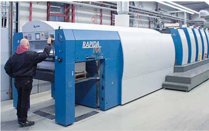
La KBA Rapida 106 installée en 2011 est équipée du système de mesure et de régulation des couleurs KBA QualiTronic ColorControl associé à System Brunner Instrument Flight
