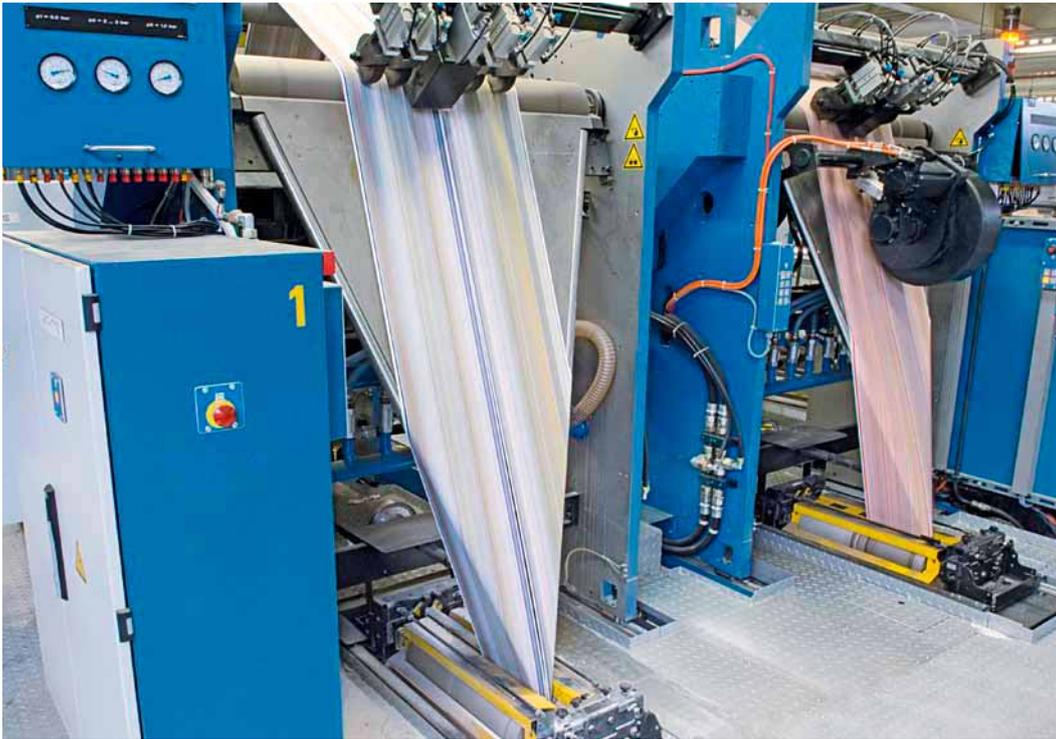
La superstructure avec skip slitter sur le second cône de pliage. Les possibilités de production inédites permises par cet équipement déchargent le façonnage et se traduisent par un gain de temps et des économies appréciables
