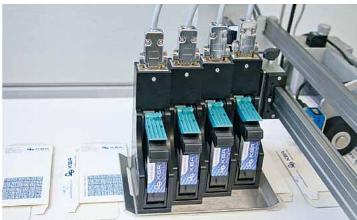
Jusqu'à quatre têtes d'impression montées en cascade permettent d'imprimer sur une largeur pouvant atteindre 2" (50,8 mm)
