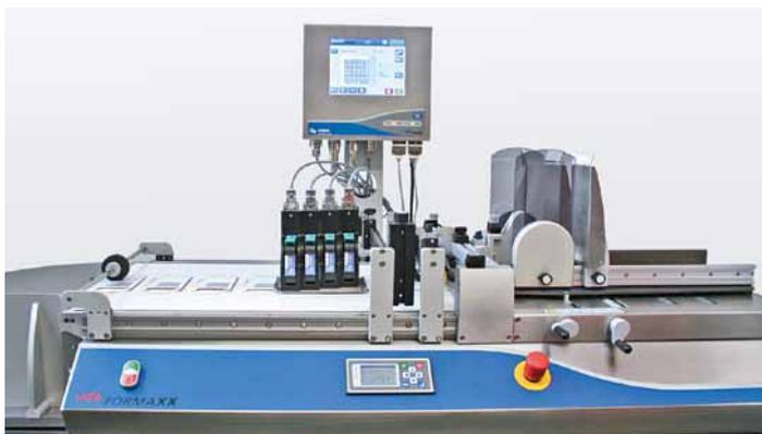
Associé au système de dépilage udeFORMAXX, le dispositif betaJET verso est idéal pour le marquage des boîtes pliantes, flans et cartons
