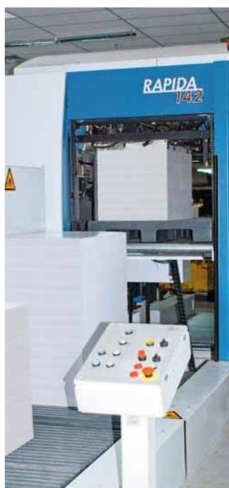
L'un des points forts de la Rapida 142 de TWP est la logistique des piles entièrement automatique – ici sur le margeur
