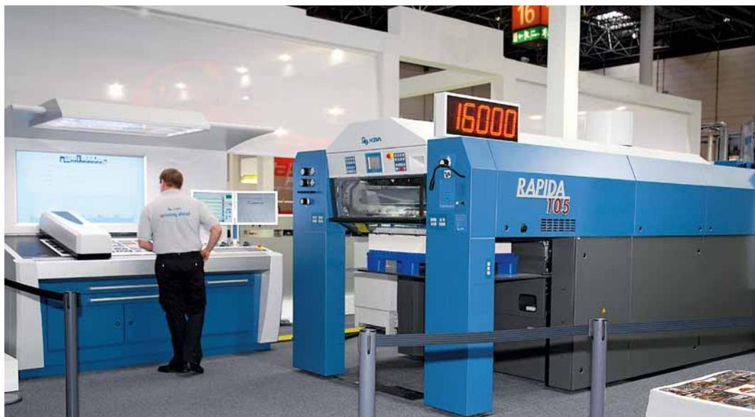
Le pupitre ErgoTronic ultramoderne de la Rapida 105 avec systèmes de mesure intégrés
