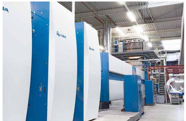
La KBA C56 SG avec sa laize maximale de 2280 mm est actuellement la seule rotative 56 pages en sens travers du marché
