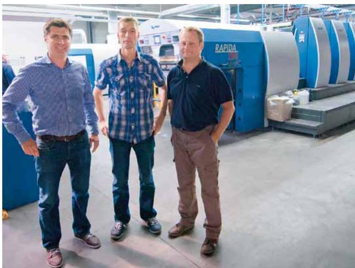
Installées côte à côte, les Rapida 106 cinq et huit couleurs utilisent le même pupitre DensiTronic pour la mesure et la régulation de l'encre
