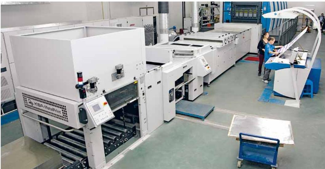
La photo montre la ligne installée dès 2012 : une MetalStar PR UV 6 couleurs avec SMS et empileur hautes performances
