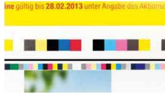
Champs de mesure pour Instrument Flight sur la Rapida (en haut, maintenant aussi 3 x 3 mm), bandes System Brunner pour QuadTech CCS en heatset (en bas)
