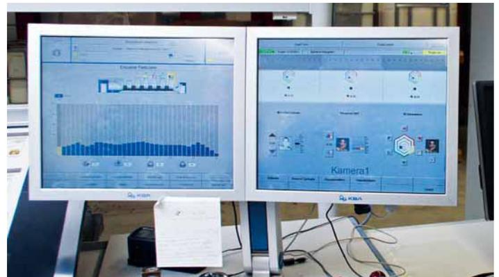
Les deux écrans tactiles affichent, à droite, Instrument Flight Balance Navigator avec ses diagrammes colorimétriques en hexagone, et, à gauche, les coulisseaux, avec les recommandations pour le lavage des blanchets
