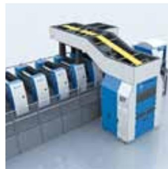
El módulo para láminas en frío Vinfoil, dispuesto lateralmente en la KBA Rapida 106 para Amcor Tobacco Packaging
