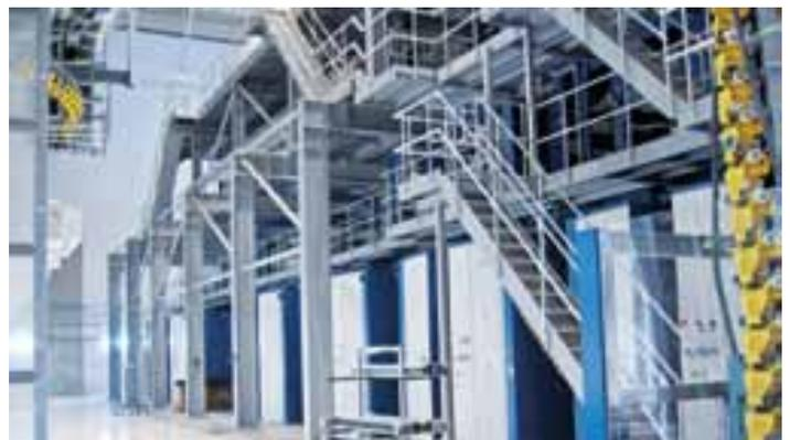
Una de las tres secciones de la máquina con cuatro torres de impresión compactas y dos secadores de aire caliente dispuestos encima de sendas secciones exteriores
