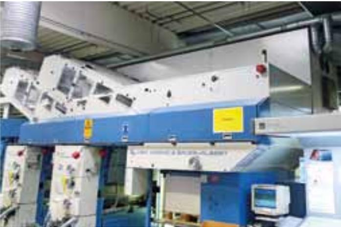
La máquina de huecogrado de pliegos de dos colores KBA Rembrandt 104 puesta en servicio en 1994 con sus tramos de secado
