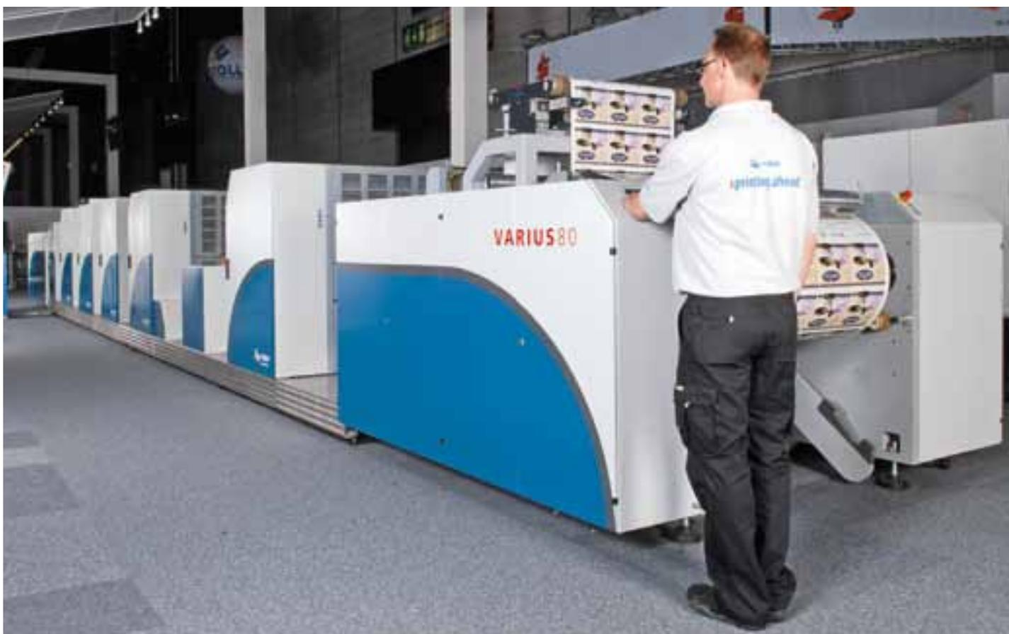
Con un ancho de banda máximo de 800 mm y una velocidad de impresión de 400 m/min, la Varius 80 de KBA-MePrint procesa soportes de impresión de 30 - 800  $\mu$ m de grosor, y tiene una longitud de impresión variable de 21 - 34".
