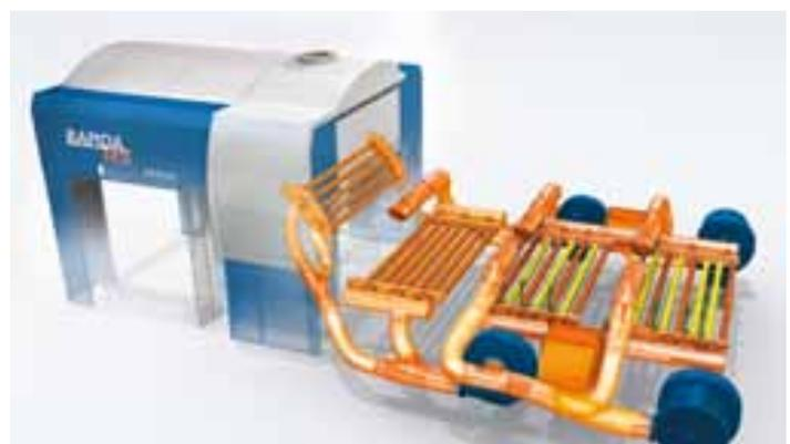
Mediante la reutilización del aire circulante usado como aire de secado se puede reducir considerablemente el consumo eléctrico de los secadores por infrarrojos/aire caliente KBA VariDry<sup>BLUE</sup> en comparación con los secadores por infrarrojos/aire caliente convencionales
