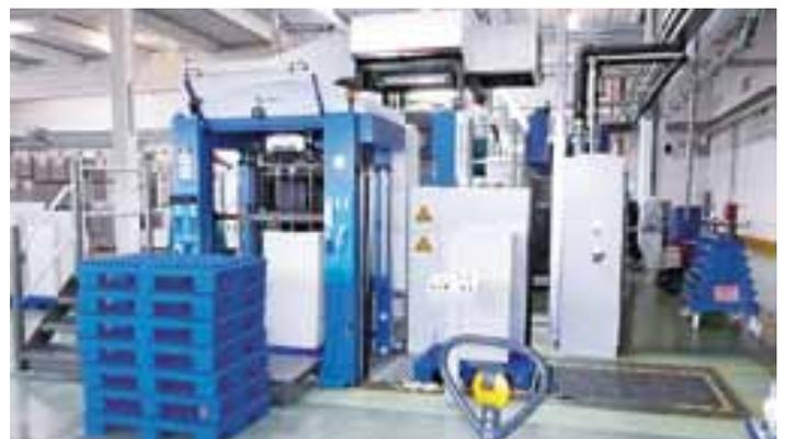
En el marcador con logística de pilas automática puede apreciarse la elevación de la máquina
