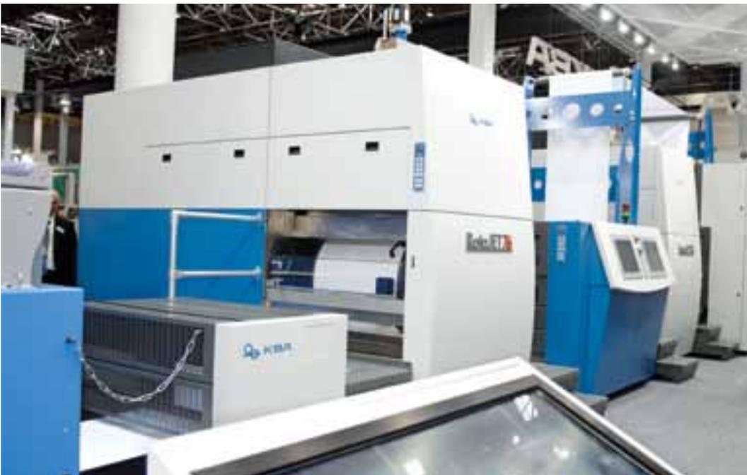
KBA ha puesto en la RotaJET su amplio know how en la construcción de máquinas de impresión, entre otros, en la conducción del papel y el control de la tensión de la banda
