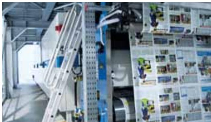
Una banda de papel SC abandona uno de los cuatro secadores heatset y se une en la superestructura de la plegadora con las bandas coldset de papel de periódico
