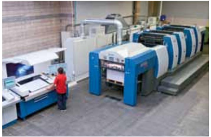
El dúo de cinco colores se ha complementado con una máquina de cuatro colores con volteo para la impresión de blanco y retirada de dos colores
