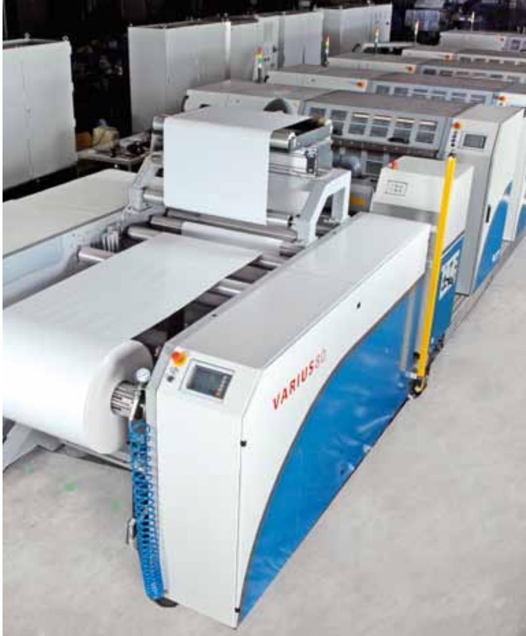
La máquina de bobina para envases de formato variable Varius 80 tiene un diseño modular, pudiéndose configurar para requisitos individuales. Aquí una vista sobre la línea de máquinas desde el desbobinado
