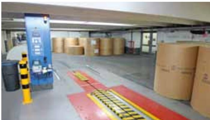
En el sótano de bobinas: aquí la estación de pesaje de la solución logística KBA Patras A
