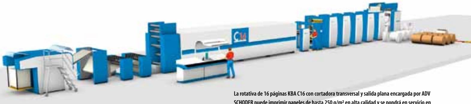
La rotativa de 16 páginas KBA C16 con cortadora transversal y salida plana encargada por ADV SCHODER puede imprimir papeles de hasta 250 g/m<sup>2</sup> en alta calidad y se pondrá en servicio en diciembre de 2012
