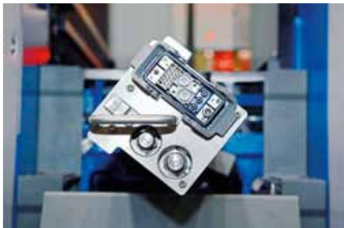
Arriba: El módulo UV-LED de la Rapida 105 se puede integrar fácilmente en las inserciones convencionales para módulos UV
