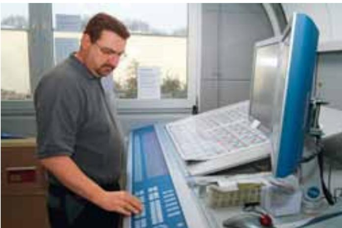
En la producción de etiquetas vale la pena que en el puesto de mando de la máquina se puedan guardar todos los datos del pedido para producciones repetitivas. De este modo, en el marcador y la salida apenas deben realizarse ajustes manuales
