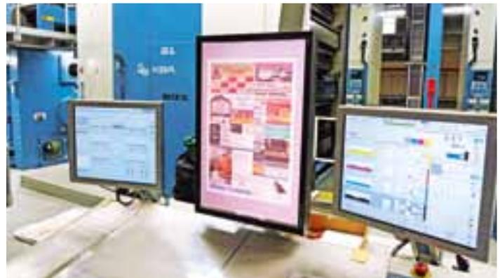
Puesto de mando ErgoTronic en la Commander CT con: pantalla de supervisión para el control del registro (izda.), pantalla para pruebas digitales (centro) y pantalla táctil para el control de la máquina (dcha.)
