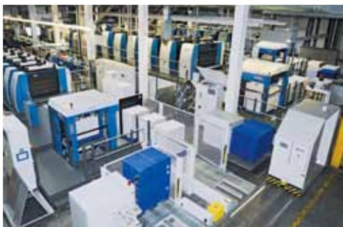
En la moderna sala de impresión de Colorpack producen dos Rapida de formato medio y otras dos de formato grande. Están integradas en una logística automática de los soportes de impresión
