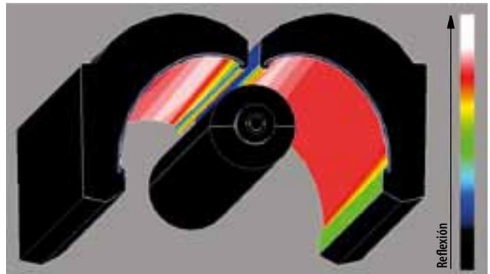
La geometría optimizada del reflector y la gestión mejorada del calor de los radiadores mejoran la eficiencia energética durante el secado
