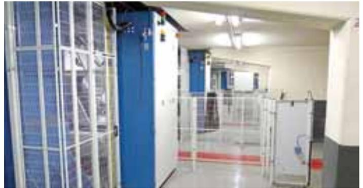
También se ajustaron a la perfección a la nave existente los cambiadores de bobinas que, debido a las dimensiones de las bobinas de la rotativa de ancho triple, están equipados con las rejillas protectoras correspondientes
