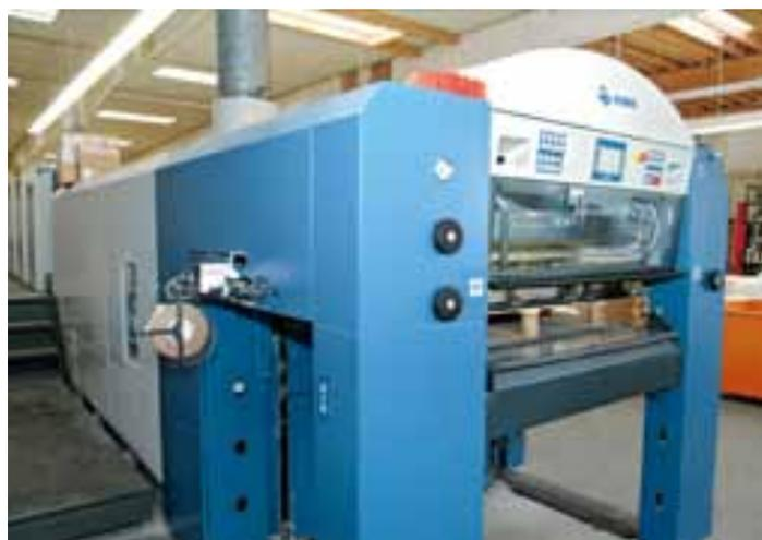
Un dispositivo de intercalado de tiras se encarga de que, tras la medición mediante QualiTronic ColorControl, la posible maculatura se pueda separar de la producción vendible
