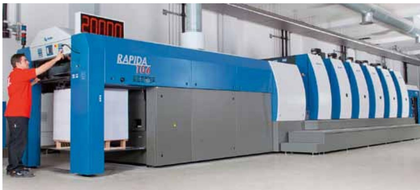
En agosto ya se puso en funcionamiento en la planta de Gersthofen de ADV SCHODER una máquina de formato medio KBA Rapida 106 con cinco cuerpos de impresión y cuerpo de lacado de dispersión
