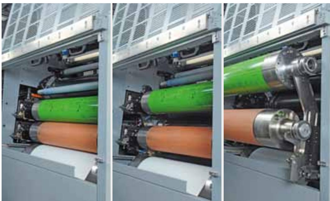
El cambio de formato se realiza en cuestión de pocos minutos. Los cilindros portaplanchas y portacaucho se cambian automáticamente. Los cilindros necesarios para el pedido siguiente se guardan temporalmente en un casete en el lado de accionamiento
