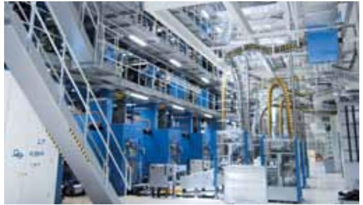
Con doce torres de impresión, doce cambiadores de bobinas, tres plegadoras y cuatro secadores de aire caliente, la gran instalación KBA Cortina llama la atención en el centro de impresión no solo por su calidad
