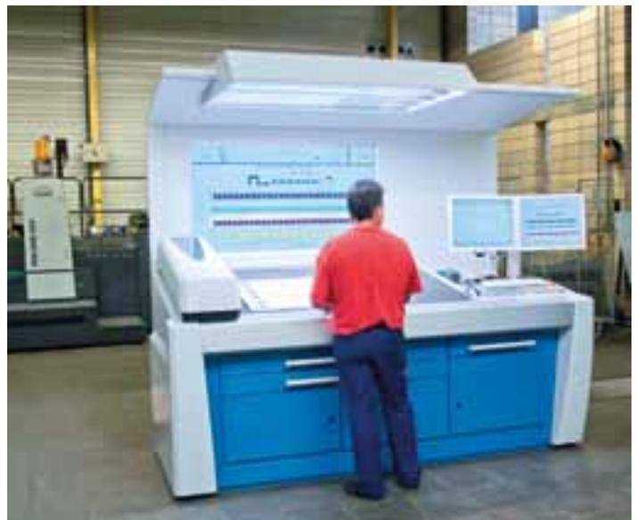
Las tres Rapida cuentan con el nuevo puesto de mando KBA ErgoTronic con pantalla en la pared, sistema de registro ACR y sistema de medición de la tinta inline KBA QualiTronic ColorControl
