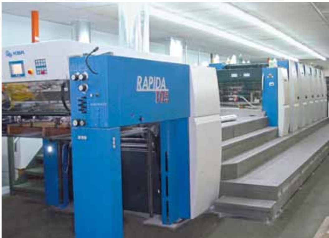
Im Frühjahr ging bei Eastern Press in Selangor, einem der ältesten Verpackungsdrucker Malaysias, eine Sechsfarben-Rapida 105 mit Lackausstattung in Betrieb
