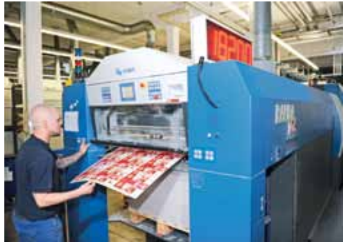
Drucker Toni Tomm hat die neue Rapida 106 voll im Griff. Bedruckstoffbedingt läuft sie im Fortdruck schon mal am ‚Anschlag‘ bei 20.000, meist aber um die 18.000 Bogen/h
