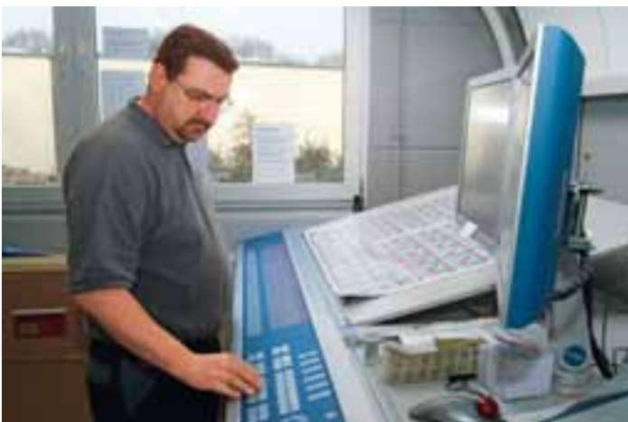
Bei der Etikettenproduktion zählt es sich aus, dass am Leitstand der Maschine alle auftragsbezogenen Daten für Wiederholproduktionen abgespeichert werden. Auch an Anleger und Auslage sind so kaum noch manuelle Einstellungen erforderlich
