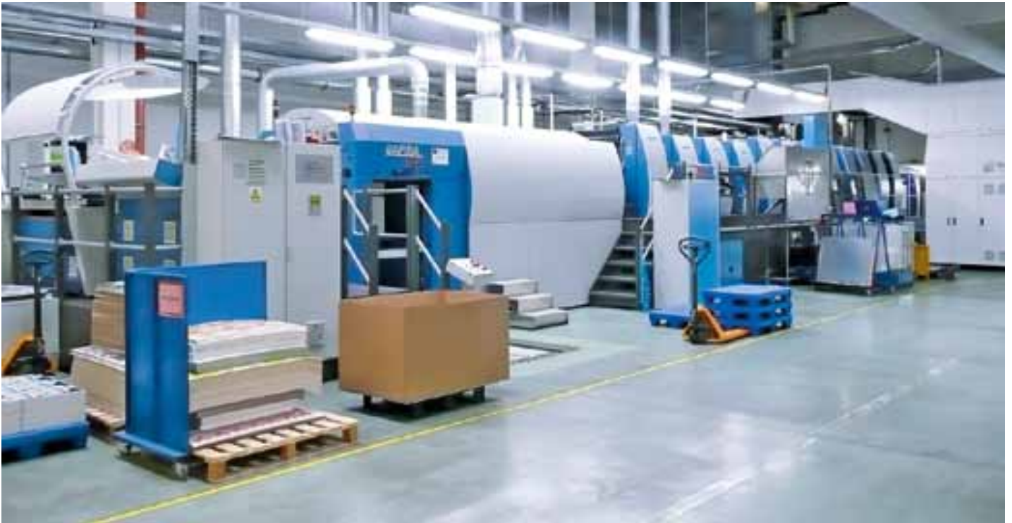
Die neue Rapida 106 bei Model Obaly ist mit zahlreichen Automatisierungs- und Veredelungskomponenten ausgerüstet. Im Hintergrund das Vinfoil-Kaltfolienmodul
