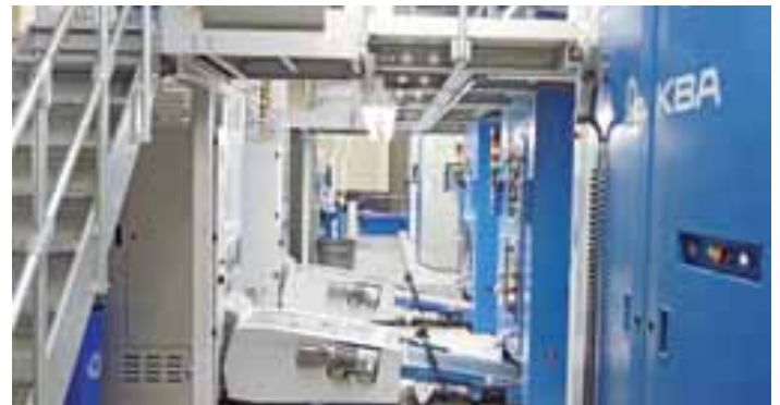
Die beiden Klappenfalzwerke und die Übergabestationen an die Ferag-Taktförderer sind mittig zwischen den vier Drucktürmen platziert
