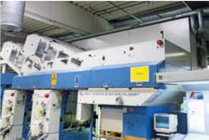
Die 1994 in Betrieb genommene Zweifarben-Bogentiefdruckmaschine KBA Rembrandt 104 mit ihren markanten Trockenstrecken
