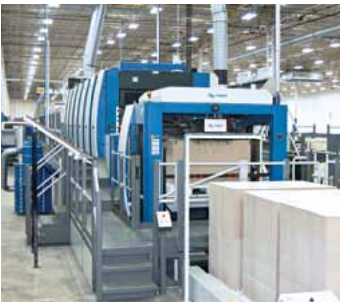
Die Rapida 145 bei WG Anderson ist in eine vollautomatische Stapellogistik eingebunden
