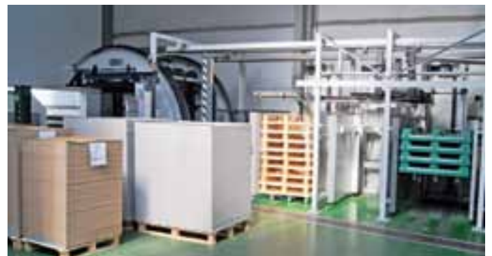
Mit einem Stapelwender werden die Bedruckstoffe von den Transport- auf Systempaletten umgesetzt
