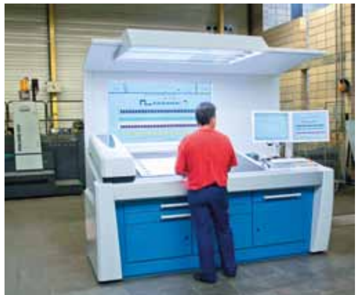
Alle drei Rapidas verfügen über den neuen KBA ErgoTronic-Leitstand mit Wallscreen, ACR-Registriersystem und Inline-Farbmesssystem KBA QualiTronic ColorControl
