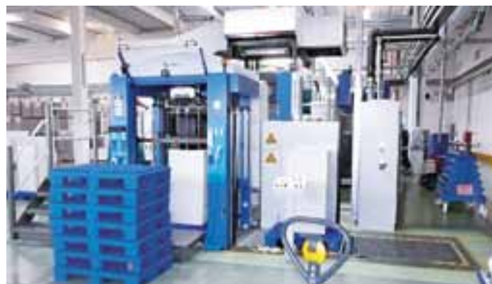
Am Anleger mit vollautomatischer Stapellogistik ist die Maschinenerhöhung gut zu erkennen
