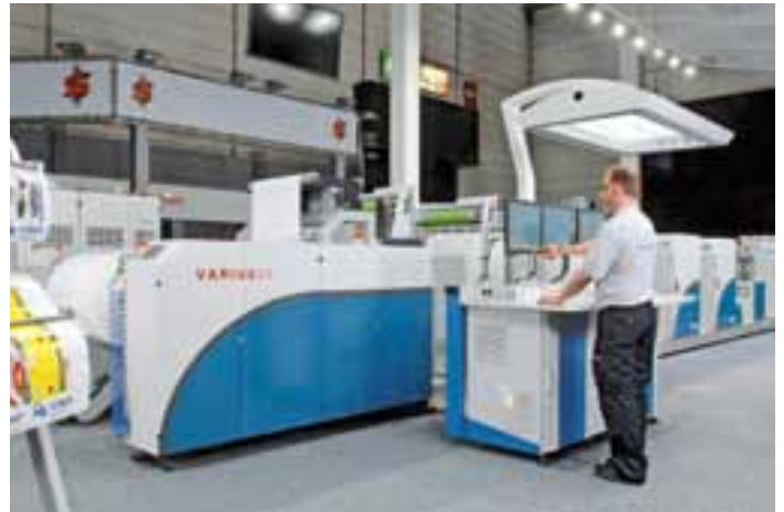
Neuer Ansatz: Mit der neuen, formatvariablen Offsetrolle Varius 80 von KBA-MePrint adressiert KBA den Wachstumsmarkt flexibler Verpackungen mit einem auf schnelle Jobwechsel, hohe Qualität, geringe Makulatur und wirtschaftliche Produktion bei kleiner werdenden Auflagen ausgerichteten Konzept
