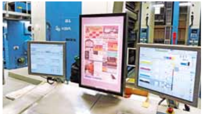
Einer der drei ErgoTronic-Leitstände an der Commander CT: Links der Überwachungsbildschirm für die Registersteuerung, in der Mitte der Softproof-Monitor, rechts der Touchscreen für die Maschinensteuerung
