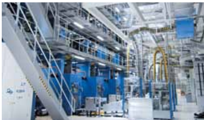
Mit zwölf Drucktürmen, ebenso vielen Rollenwechslern, drei Falzwerken und vier Heißlufttrocknern beeindruckt die KBA Cortina-Großanlage jeden Besucher im neuen Druckzentrum nicht nur durch ihre Druckqualität
