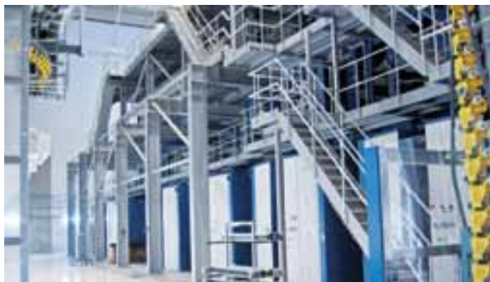
Eine der drei Maschinensektionen mit jeweils vier kompakten Drucktürmen und je zwei über den beiden äußeren Sektionen angeordneten Heißlufttrocknern
