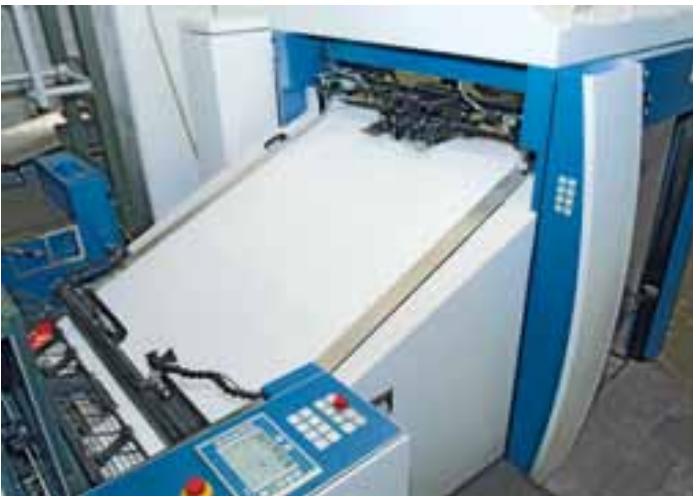
Die Rapida 106 bei ak-medien ist u. a. mit ziehmarkenfreier Anlage DriveTronic SIS ausgestattet
