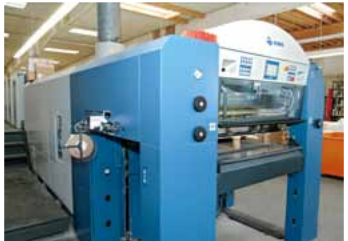
Ein Streifeneinschießgerät sorgt dafür, dass nach der Messung durch QualiTronic ColorControl eventuelle Makulatur von verkaufbarer Produktion getrennt werden kann
