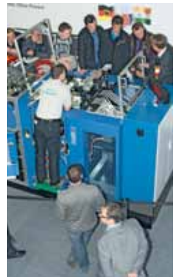
Anlaufpunkt für Rollenoffsetdrucker: Der neue 3. Falz der C16 mit einer wartungsarmen Bänderspannung für Geschwindigkeiten bis 65.000 Expl./h
