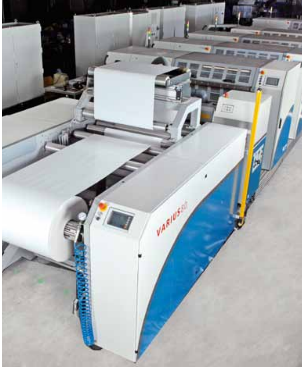
Die formatvariable Verpackungsrolle Varius 80 ist modular aufgebaut und kann so für individuelle Anforderungen konfiguriert werden. Hier der Blick auf die Maschinenlinie von der Abrollung
