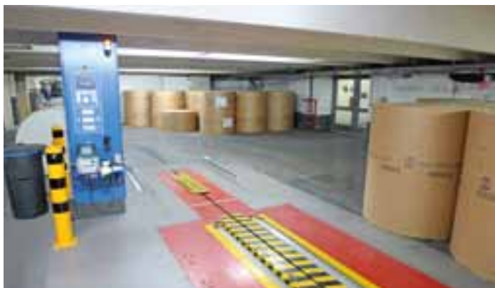
Im Rollenkeller: Hier die Wiegestation der KBA-Logistiklösung Patras A
