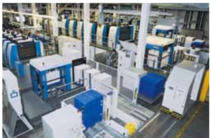
Im modernen Drucksaal von Colorpack produzieren zwei mittelformatige und zwei großformatige Rapidas. Alle Maschinen sind in eine automatische Bedruckstofflogistik integriert
