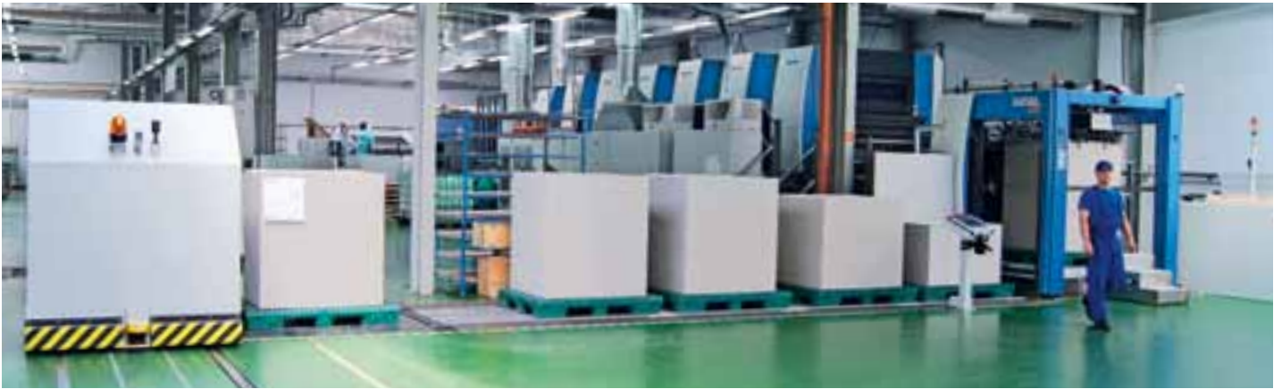
Die Rapida 145 bei Karton-Pak ist in eine automatisierte Bedruckstofflogistik eingebunden
