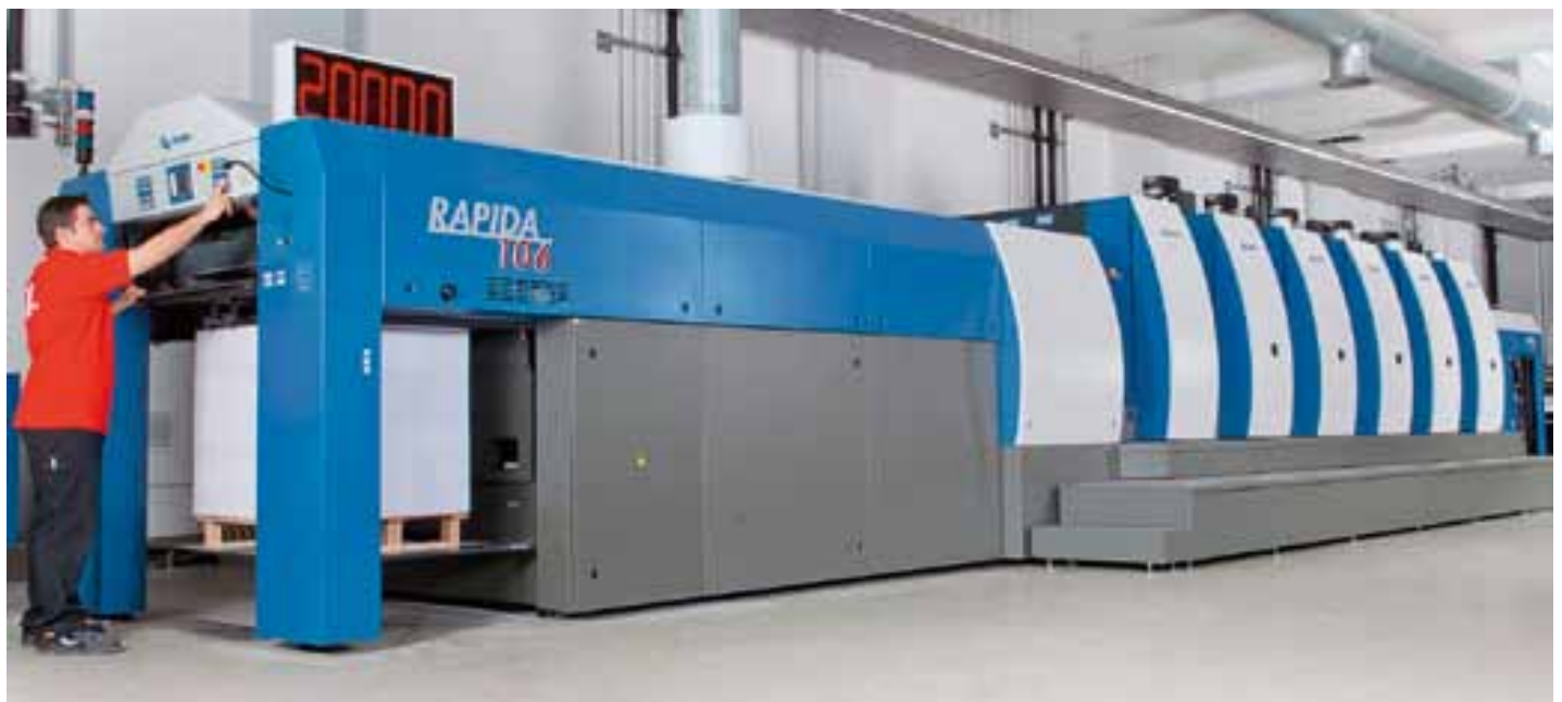
Bereits im August lief im Werk Gersthofen von ADV SCHODER eine Mittelformatmaschine KBA Rapida 106 mit fünf Druckwerken und Dispersionslackwerk an
