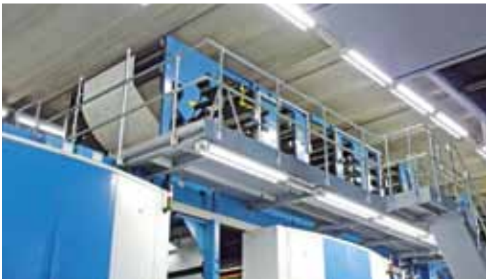
Passt genau: Gerade einmal 40 Zentimeter Platz sind noch zwischen dem Überbau der Commander CT und der Hallendecke
