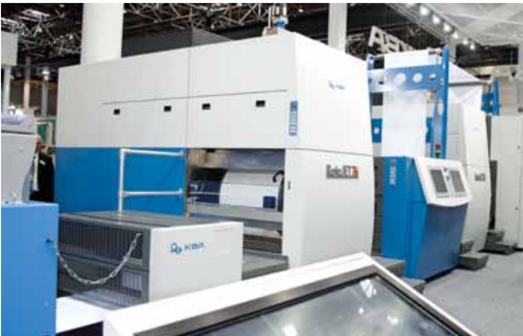
In der Rota JET hat KBA sein umfassendes Know-how im Druckmaschinenbau umgesetzt, u. a. bei der Papierführung und Bahnspannungskontrolle
