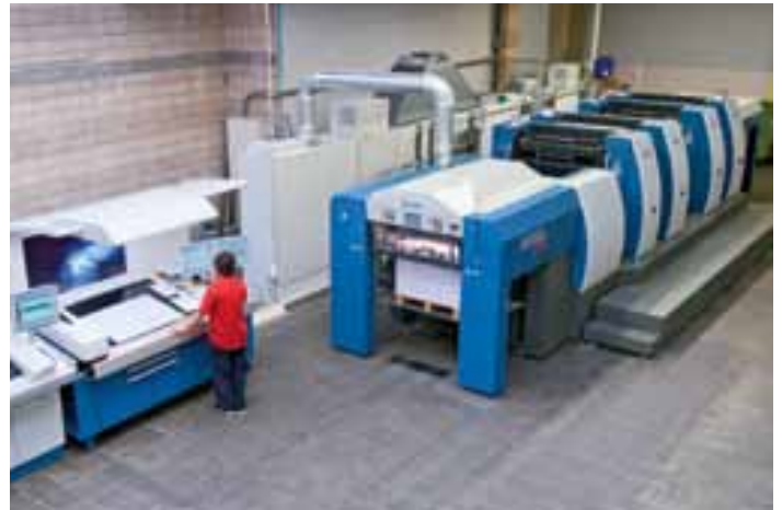
Das Fünffarben-Duo wurde um eine Vierfarbenmaschine mit Wendung für den zweifarbigem Schön- und Widerdruck ergänzt
