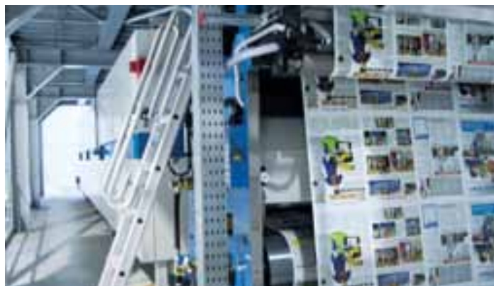
Eine SC-Papierbahn verlässt einen der vier Heatset-Trockner und wird dann im Falzwerk-Überbau mit den Coldset-Bahnen aus Zeitungspapier vereinigt
