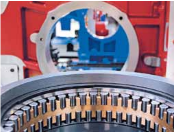
Spielfreie Wälzlager werden an den Rapida-Maschinen schon seit Langem eingesetzt. Auch sie tragen zur Reduzierung des Energieverbrauchs bei
