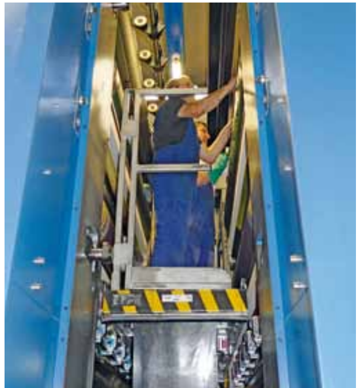
Die BNN-Drucker schätzen den bequemen Zugang zu den auseinander fahrbaren Druckwerken per Lift
