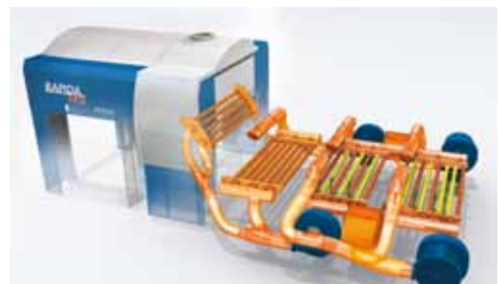
Durch die Wiederverwendung der als Trocknungsluft eingesetzten Umluft kann der Strombedarf der KBA VariDry BLUE -Infrarot/Thermoluft-Trockner im Vergleich zu konventionellen Infrarot/Thermoluft-Trocknern deutlich reduziert werden
