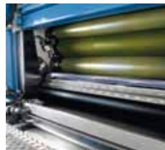
Con el cierre automatizado de rodillos KBA RollerTronic se pueden ajustar todos los sistemas de entintado en cuestión de dos minutos, de forma automática pulsando un botón en el puesto de mando
