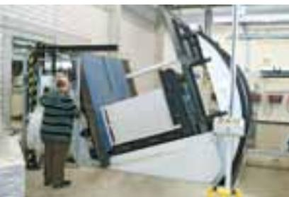
En el umbral entre el almacén de material y la sala de impresión, un volteador de pilas se encarga de colocar éstas sobre palés nonstop
