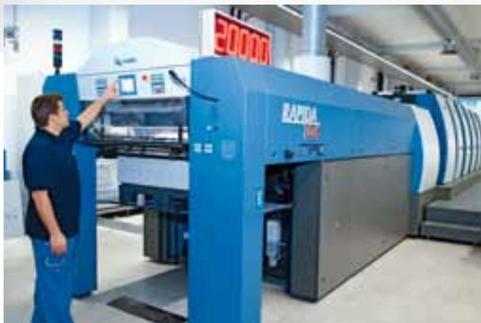
La campeona en tiempos de preparación Rapida 106 tendrá a partir de Drupa un rendimiento máximo aumentado a 20.000 pliegos/h (con paquete de alta velocidad)
