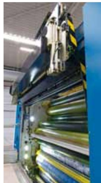
En el futuro una opción para todas las máquinas de doble perímetro C: el dispositivo totalmente automático de cambio de planchas realiza el cambio en dos minutos independientemente del número total de planchas
