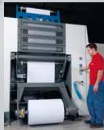
El desbobinador con regulador de tensión integrado –desarrollado por KBA para la RotaJET– garantiza una tensión de banda muy precisa en la entrada en el cuerpo de impresión y, junto con el dispositivo de introducción, ofrece otras propiedades que hasta ahora no eran habituales en las instalaciones de impresión digital
