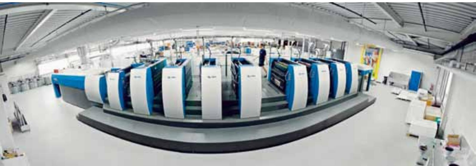
Una máquina poco habitual en una perspectiva poco habitual. La Rapida 106 SPC de ocho colores, con volteo, torre de laca de última generación, Flying JobChange y sistema de regulación del color KBA QualiTronic Color Control con Instrument Flight de System Brunner ha revolucionado el quehacer diario en Jordi
