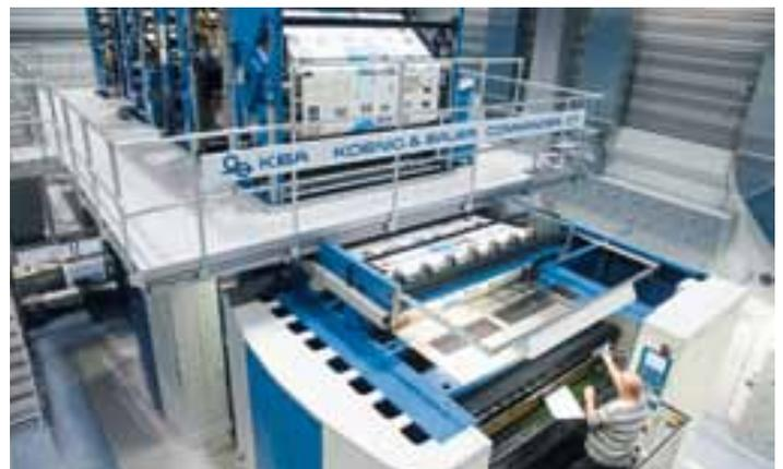
Cambio de tirada en unos pocos minutos gracias al ascensor que permite un fácil acceso a las unidades y al robot cambiaplanchas PlateTronic, que puede alimentarse en plena producción
