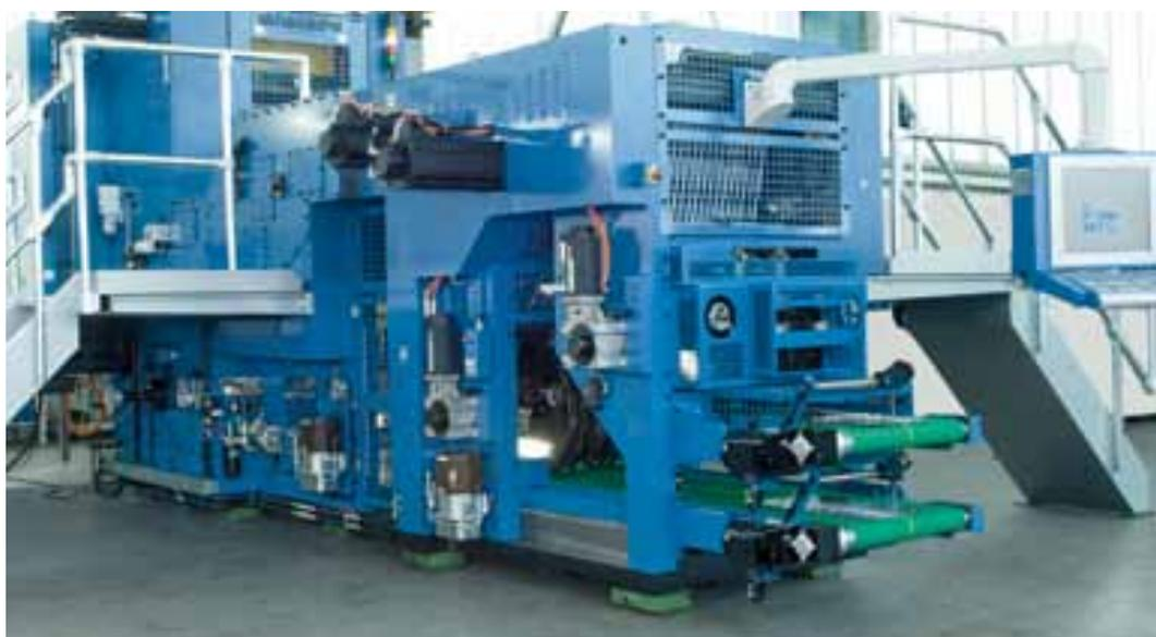
En las plegadoras, un nuevo sistema neumático de tensión garantiza una tensión constante de las cintas y un desgaste inferior de las mismas
