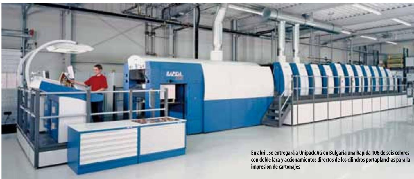
En abril, se entregará a Unipack AG en Bulgaria una Rapida 106 de seis colores con doble laca y accionamientos directos de los cilindros portaplanchas para la impresión de cartonajes
