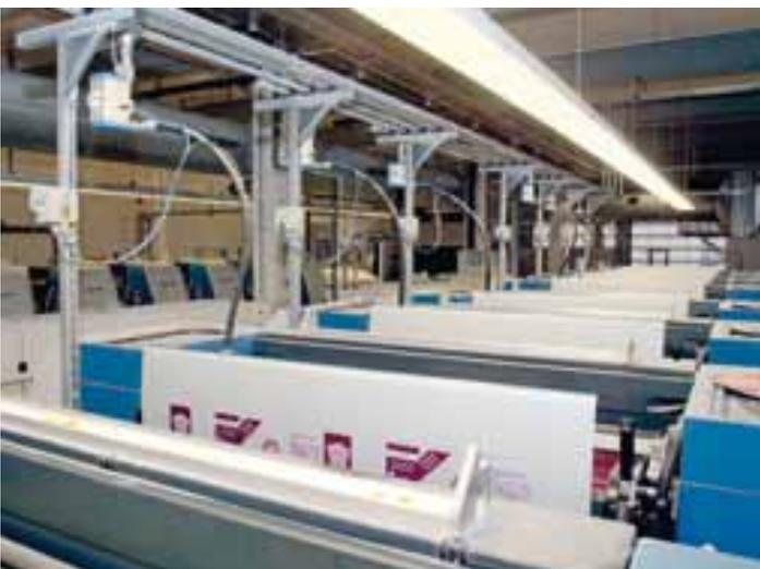
La RA 106 de ocho colores está conectada con una alimentación de tinta totalmente automática. En el caso de la máquina de seis colores se renunció a ello debido a la frecuencia de tintas especiales
