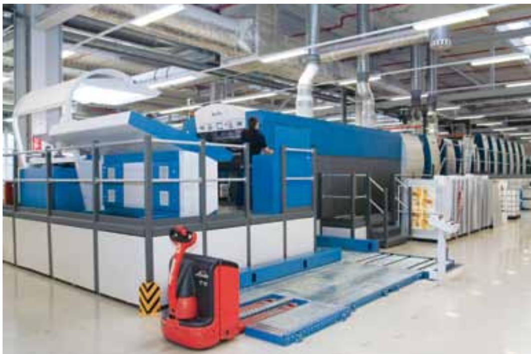
La nueva Rapida 145 de Leopold Verpackungen se distingue, a ojos de un experto, en la salida "highline", que tiene un color distinto
