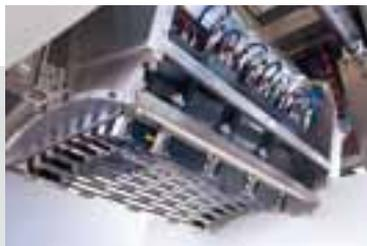
Vista de una de ambas filas de cabezales de impresión con 56 cabezales de inyección de tinta con orientación exacta de calidad superior
