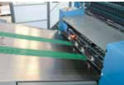
Limpiamente: en la mesa de marcador ya no hay que ajustar poleas o cepillos. La luz roja procede de la alimentación DriveTronic SIS sin tacones de arrastre
