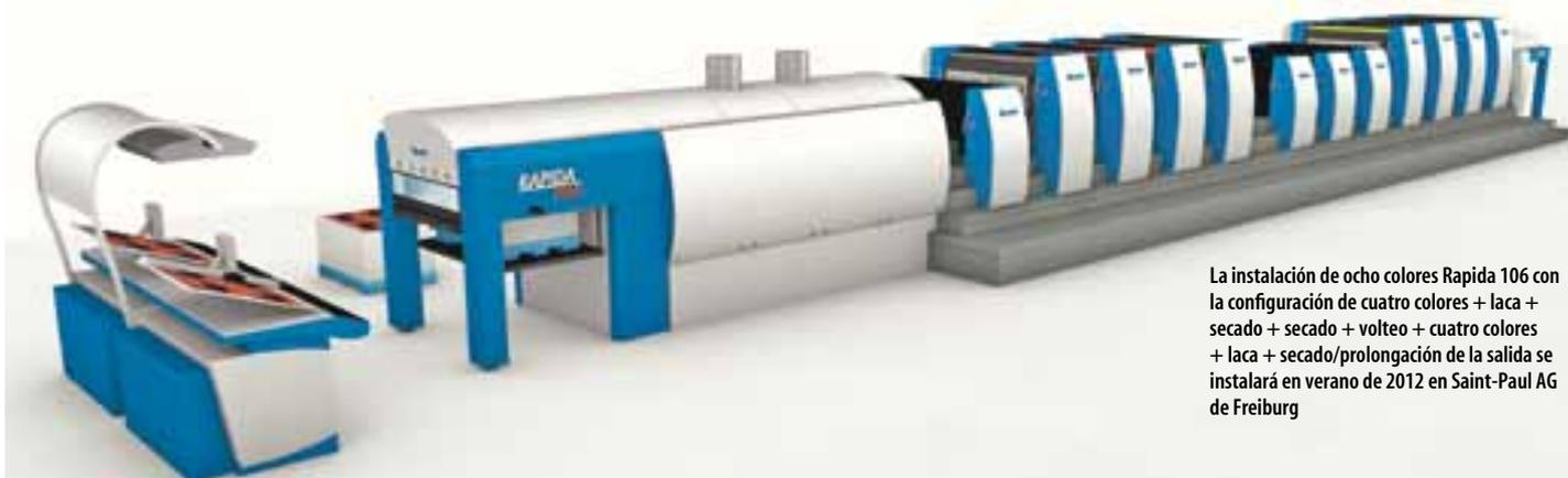
La instalación de ocho colores Rapida 106 con la configuración de cuatro colores + laca + secado + secado + volteo + cuatro colores + laca + secado/prolongación de la salida se instalará en verano de 2012 en Saint-Paul AG de Freiburg
