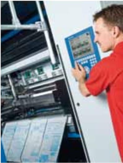
La unidad impresora de tan solo 2,5 m de altura de la nueva rotativa de periódicos modular KBA Commander CL con cambio de planchas totalmente automático
