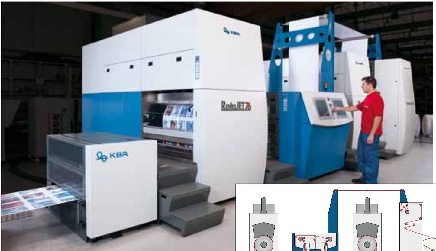
La KBA RotaJET 76 es una rotativa de inyección de tinta de última generación para aplicaciones industriales de impresión digital con elevadas exigencias
