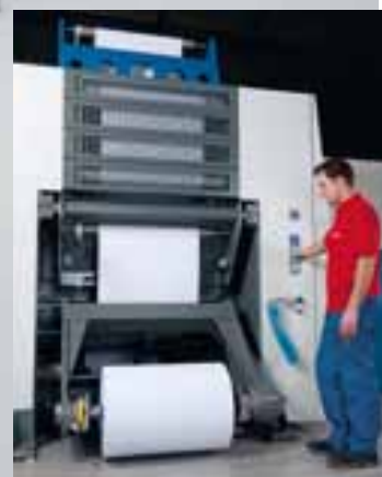
Lo sbobinatore sviluppato da KBA per la RotaJET con gruppo di avanzamento integrato e variabile tende il nastro al suo ingresso nel gruppo di stampa con estrema precisione e sicurezza e, oltre al dispositivo di alimentazione automatico, presenta altre funzioni intelligenti nuove agli impianti di stampa digitale
