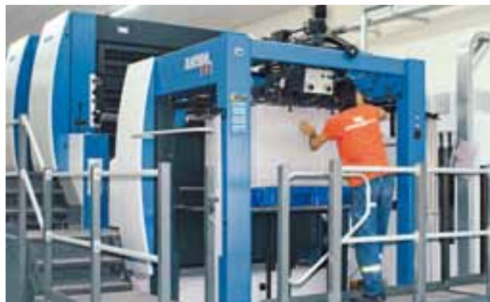
La macchina a formato grande messa in opera nel marzo 2011 alla Kombassan è stata rialzata per la stampa di cartonaggi
