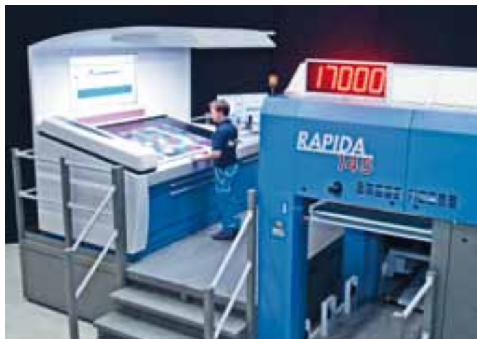
Panoramica dell'uscita Venturi in alto della nuova serie Rapida 145 sul nuovo pulpito di comando ErgoTronic con tecnica di misura e regolazione integrata
