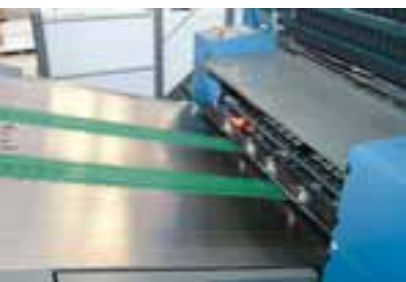
Perfetto: sulla tavola del mettfoglio non occorre regolare né rulli né spazzole. La luce rossa proviene dall'alimentazione senza squadra DriveTronic SIS
