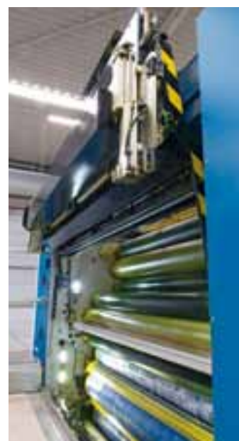
Futura opzione per tutte le macchine a doppia circonferenza serie C: il cambiastre completamente automatico cambia tutte le lastre in due minuti, indipendentemente dal numero
