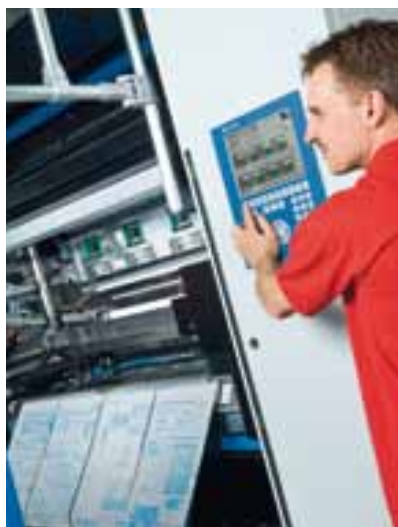
L'unità di stampa ad H di soli 2,5 metri di altezza della nuova rotativa modulare per quotidiani KBA Commander CL con cambialastre completamente automatico
