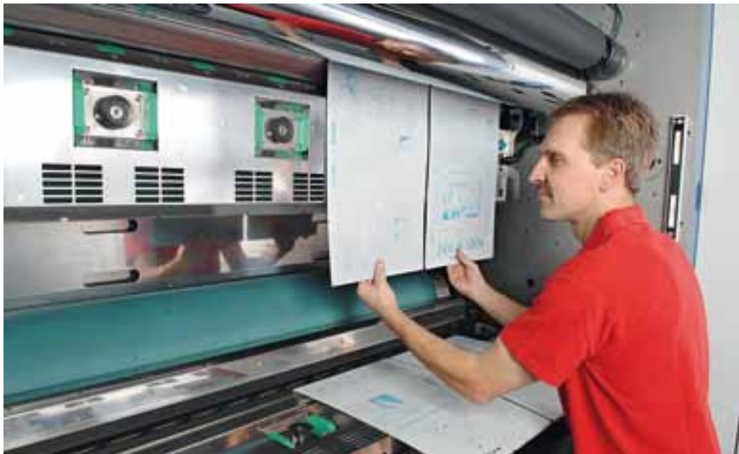
Per ridurre i tempi di allestimento, la KBA Commander CL può essere dotata di cambialastre semiautomatici (nella foto) o completamente automatici
