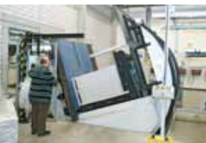
Alla barriera tra il magazzino materiali e la sala stampa, tutte le pile vengono trasferite su pallet nonstop da un voltpila
