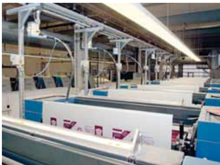
La Rapida 106 a otto colori è collegata ad un'alimentazione di inchiostro completamente automatica. Visto l'impiego di inchiostri speciali, la sei colori non ha l'alimentazione automatica
