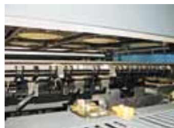
Le nuove barre portapinze aerodinamiche impediscono vorticosità nell'uscita
