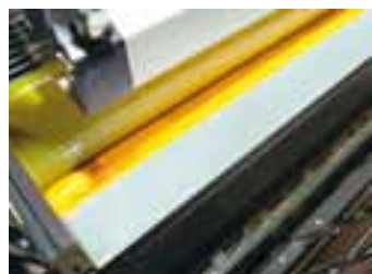
Piccolo dettaglio, grande effetto: uno speciale film per pulire il calamaio con estrema rapidità
