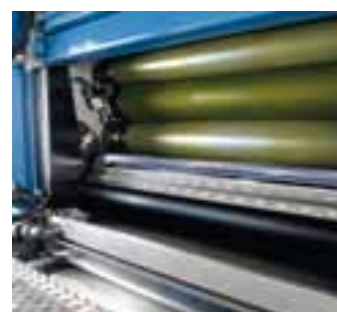
Con il blocco dei rulli automatizzato KBA RollerTronic si possono regolare automaticamente dal pulpito di comando e con un solo tasto tutti i rulli inchiostriatori in due minuti
