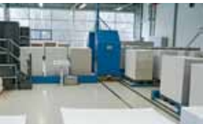
Logistica di impilaggio completamente automatica per tre Rapida in formato jumbo. Una slitta di trasporto porta le pile pronte alle stazioni tampone dei mettfoglio
