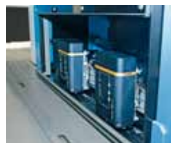
Digital joins Offset: la Rapida 105 sarà dotata di testine a getto d'inchiostro della Atlantic Zeiser per sovrastampe e codifiche personalizzate
