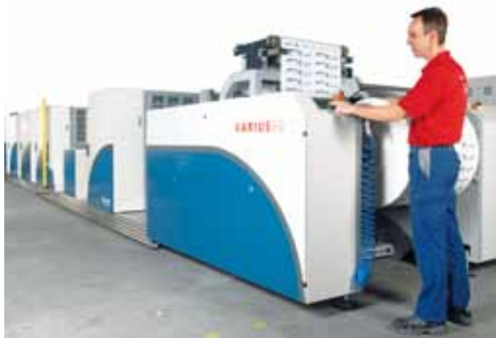
La nuova Varius 80 in formato variabile di KBA-MePrint stampa imballaggi flessibili in offset senz'acqua UV
