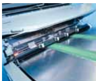
La Rapida 145 è dotata di una tavola mettfoglio con soli due nastri aspiratori e dell'alimentazione senza squadra DriveTronic SIS già collaudata sulla Rapida 106
