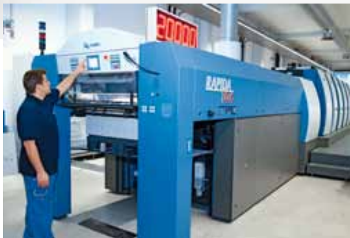
La Rapida 106, championne du monde du temps de calage, verra à partir de la drupa sa vitesse maximale portée à 20 000 feuilles/h (avec module high-speed)
