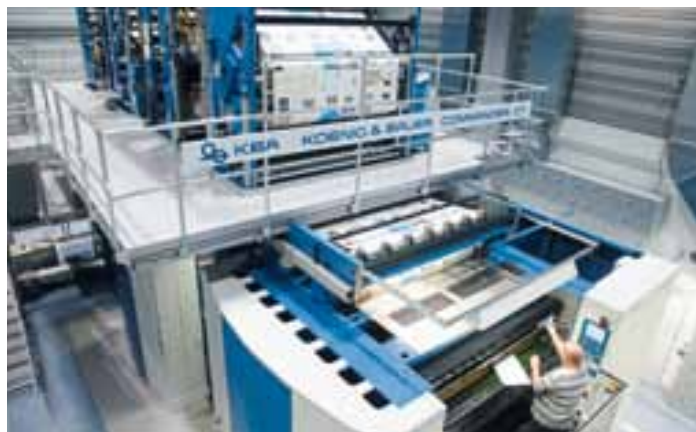
Changement de tirage ultrarapide grâce à l'accès aux encrages facilité par les élévateurs et aux changeurs automatiques de plaques PlateTronic, qui peuvent être chargés en cours de production
