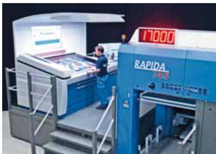
Aperçu de la réception Venturi surélevée de la nouvelle série Rapida 145 et du nouveau pupitre ErgoTronic avec système de mesurage et de régulation intégré
