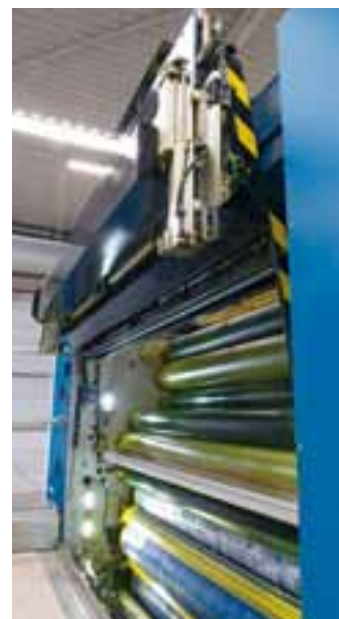
En option désormais sur toutes les rotatives à double développement de la série C : le changeur entièrement automatique assure le changement de toutes les plaques, quel qu'en soit le nombre, en deux minutes
