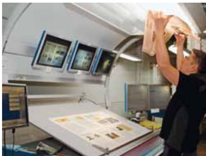
Par habitude, le conducteur Hans-Jörg Bellmann vérifie le repérage d'un travail recto-verso
