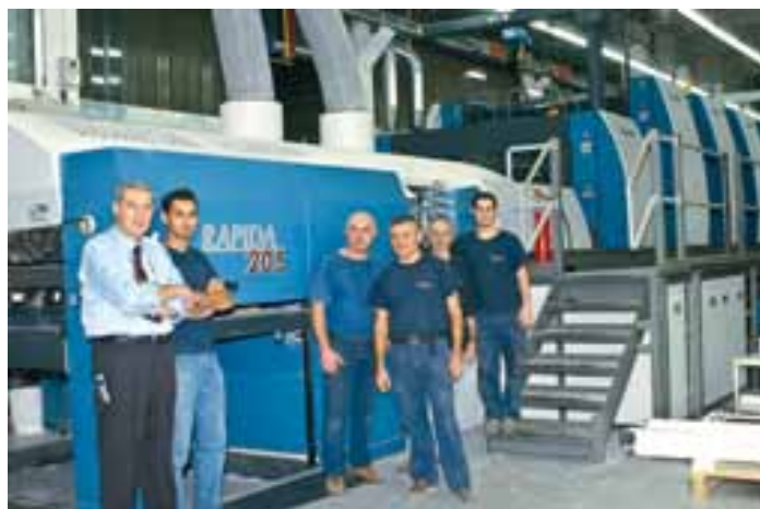
Earth Platinum a été imprimé en Italie chez Litorama div. Igap sur une KBA Rapida 205 très grand format avec cinq couleurs et tour de vernissage entrée en service en 2005
