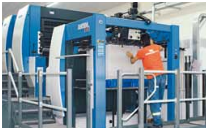
La presse grand format entrée en service en mars 2011 chez Kombassan a été rehaussée pour le carton
