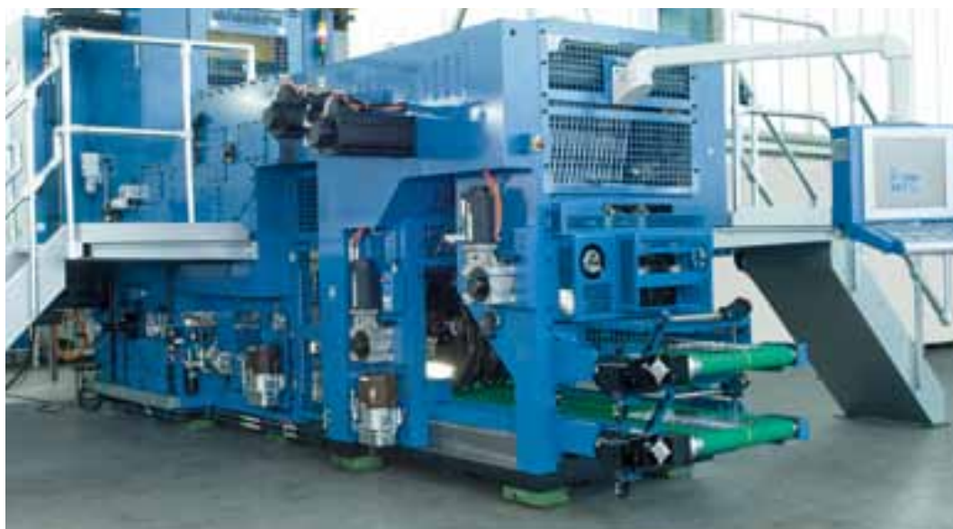
Dans les plieuses, un nouveau système pneumatique assure la tension constante des cordons tout en réduisant nettement l'usure
