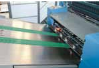
Une solution géniale : sur la table de marge, il n'y a plus ni roulettes ni brosses à régler. La lumière rouge provient de la marge sans guide latéral DriveTronic SIS
