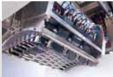
Aperçu de l'une des deux batteries de têtes d'impression, comprenant chacune 56 têtes jet d'encre de très haute qualité avec un stitching très précis
