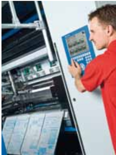
Le groupe d'impression haut de 2,5 m seulement de la nouvelle rotative de presse modulaire KBA Commander CL avec changeur de plaques entièrement automatique
