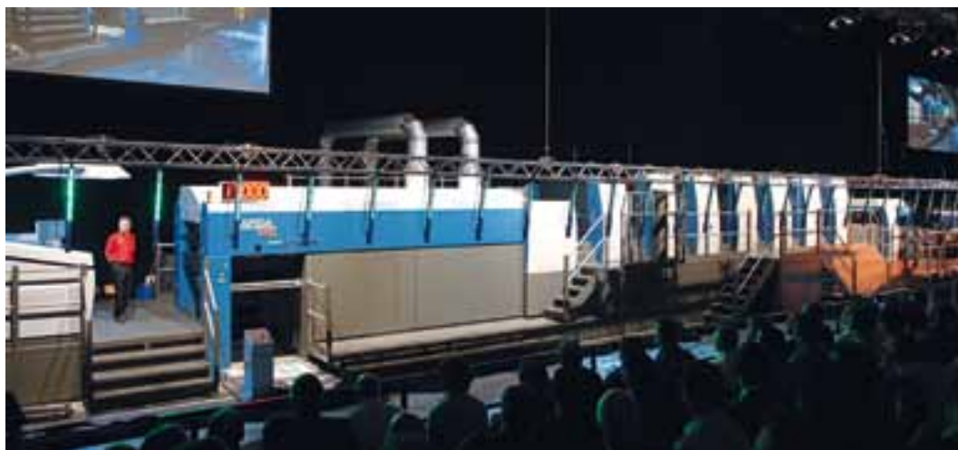
La nouvelle génération Rapida 145 entièrement automatisée, championne du monde du temps de calage en grand format, détient de plus le record absolu de vitesse de roulage dans cette catégorie de format avec 17 000 f/h en ligne et 15 000 f/h en impression 4/4
