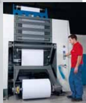
Le dérouleur mis au point par KBA pour la RotaJET avec débiteur réglé intégré assure une tension très précise de la bande à l'entrée du groupe d'impression et offre, en plus du système d'engagement automatique, d'autres fonctionnalités jusqu'à présent inédites en impression numérique
