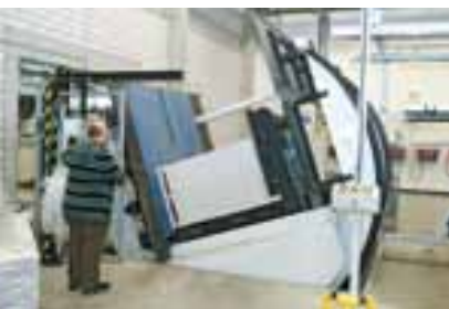
À l'entrée de l'atelier, toutes les piles en provenance du magasin de papier sont placées sur des palettes non-stop par un retourneur de pile
