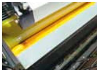
Kleines Detail, große Wirkung: Eine spezielle Folie erlaubt die schnelle Farbkastenreinigung
