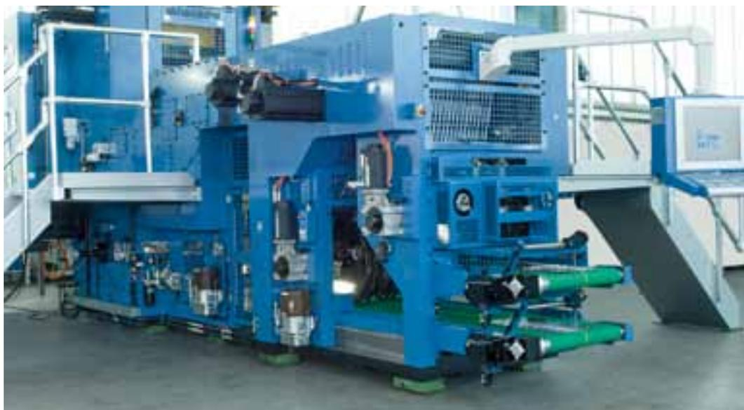
In den Falzapparaten sorgt ein neues pneumatisches Spannsystem für eine konstante Bänderspannung und deutlich geringeren Bänderverschleiß
