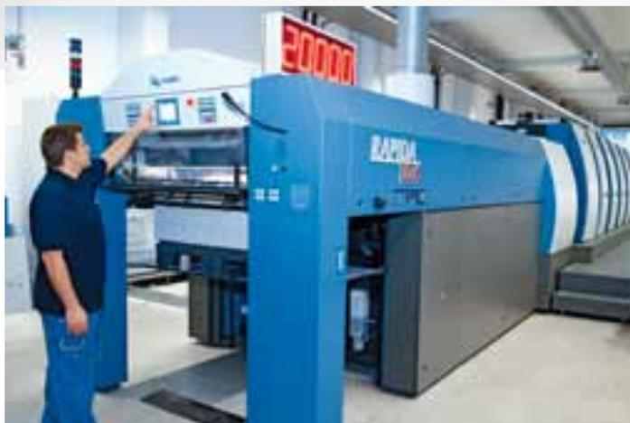
Der Rüstzeitweltmeister Rapida 106 hat ab der drupa eine auf 20.000 Bogen/h gesteigerte maximale Druckleistung (mit High-Speed-Paket)
