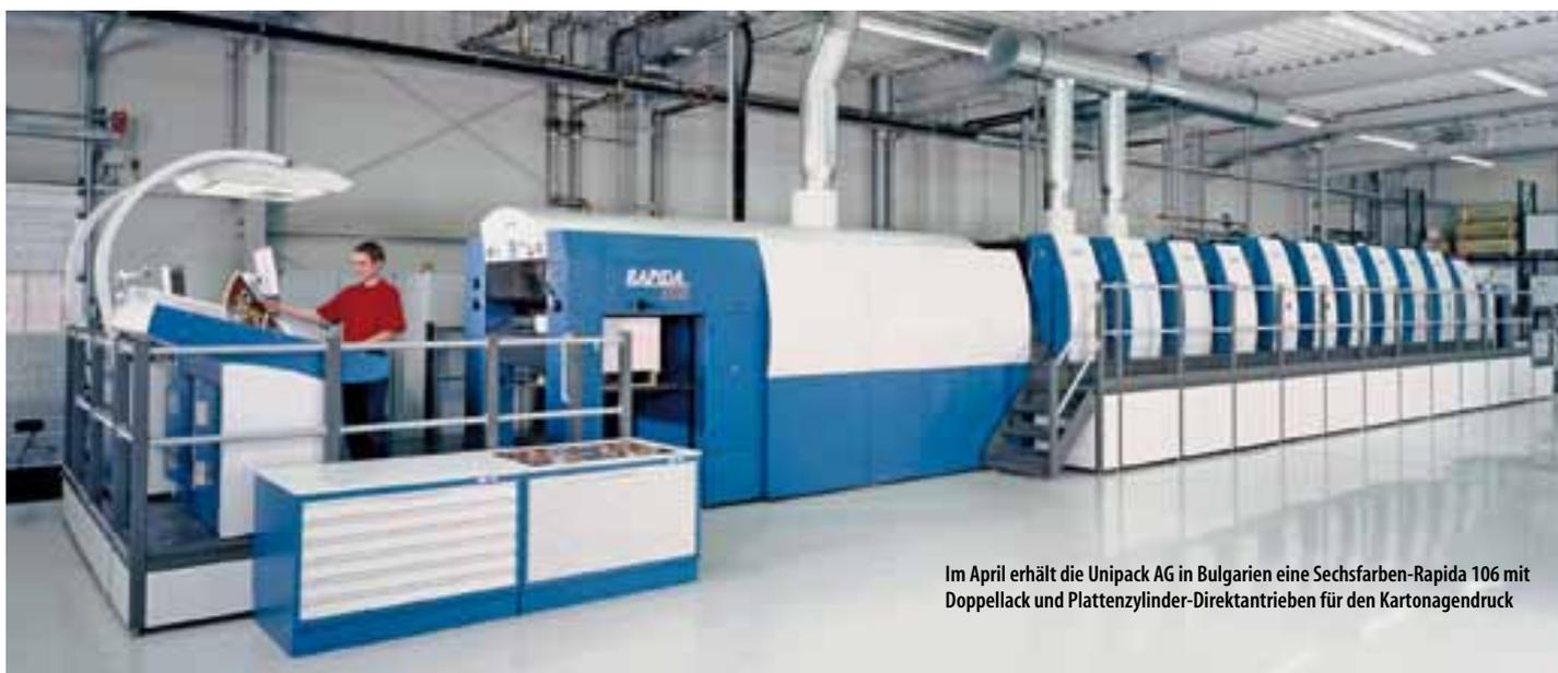
Im April erhält die Unipack AG in Bulgarien eine Sechsfarben-Rapida 106 mit Doppellack und Plattenzylinder-Direktantrieben für den Kartonagendruck
