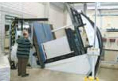
An der Schleuse zwischen Materiallager und Drucksaal werden durch einen Stapelwender alle Stapel auf Nonstop-Paletten umgesetzt
