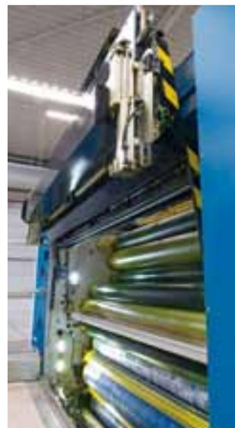
Künftig eine Option für alle C-Doppelumfangmaschinen: Der Plattenwechsel-Vollautomat wechselt unabhängig von der Zahl alle Platten in zwei Minuten
