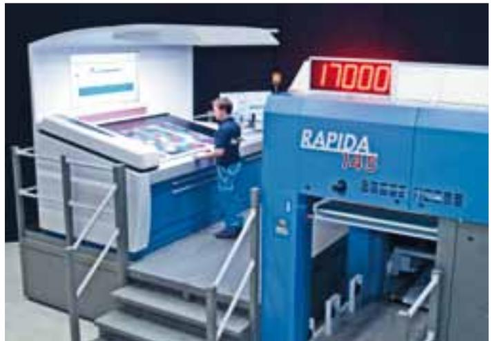
Blick über die oben liegende Venturi-Auslage der neuen Rapida 145-Baureihe auf den neuen ErgoTronic-Leitstand mit integrierter Mess- und Regeltechnik
