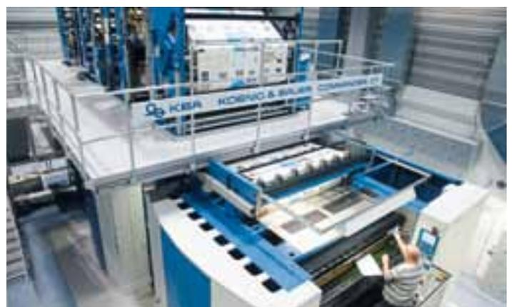
Auflagenwechsel innerhalb weniger Minuten dank der über einen Lift optimal zugänglichen Druckstellen und der bei laufender Produktion bestückbaren PlateTronic-Plattenautomaten
