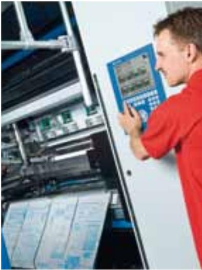
Die nur 2,5 m hohe Druckeinheit der neuen, modularen Zeitungsrotation KBA Commander CL mit vollautomatischem Plattenwechsel
