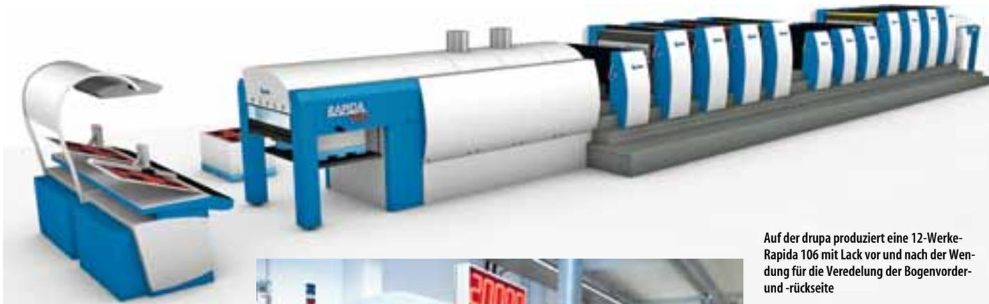
Auf der drupa produziert eine 12-Werke-Rapida 106 mit Lack vor und nach der Wendung für die Veredelung der Bogenvorder- und -rückseite
