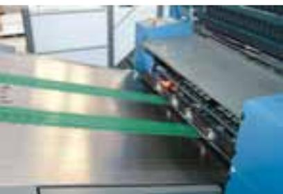
Saubere Sache: Am Anlegtisch müssen keine Rollen oder Bürsten eingestellt werden. Das rote Licht kommt von der ziehmarkenfreien Anlage DriveTronic SIS
