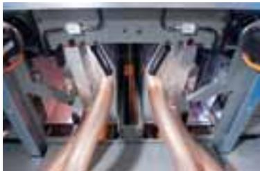
In der RotaJET kommt ein energiesparender IR-Trockner von KBA zum Einsatz
