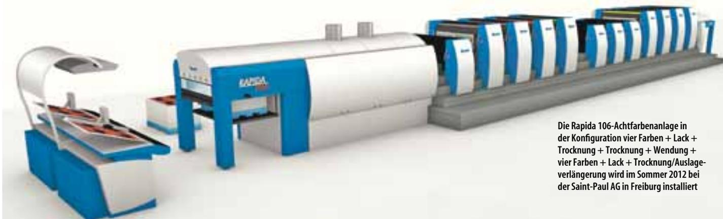
Die Rapida 106-Achtfarbanlage in der Konfiguration vier Farben + Lack + Trocknung + Trocknung + Wendung + vier Farben + Lack + Trocknung/Auslageverlängerung wird im Sommer 2012 bei der Saint-Paul AG in Freiburg installiert
