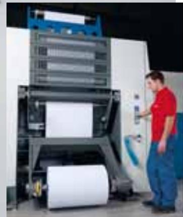
Der von KBA für die RotaJET entwickelte Abroller mit integriertem, regeltem Einzugwerk stellt beim Druckwerkeinlauf eine sehr präzise Bahnspannung sicher und bietet neben der automatischen Einzugvorrichtung weitere Features, die bisher an Digitaldruckanlagen nicht üblich waren
