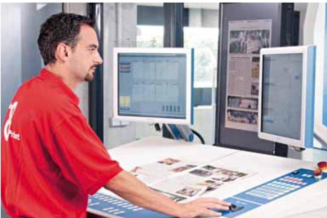
Ergonomische Bedienung über den KBA ErgoTronic-Leitstand
