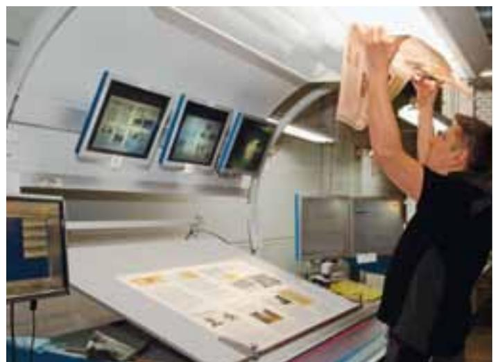
Drucker Hans-Jörg Bellmann prüft aus alter Gewohnheit das Register eines Schön- und Widerdruck-Auftrages
