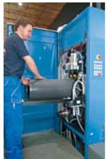
Der neue Lackturm der Rapida 145 ermöglicht den simultanen Lackformwechsel mit DriveTronic SFC und kann mit von nur einem Bediener schnell zu wechselnden Anilox-Sleeves (AniSleeve) ausgestattet werden
