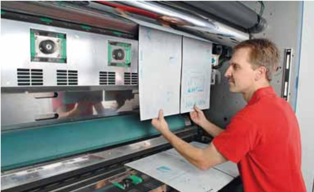
Zur Rüstzeitverkürzung kann die KBA Commander CL optional mit halb- (im Bild) oder vollautomatischem Plattenwechsel ausgestattet werden
