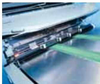
Die Rapida 145 verfügt über einen Saugbändertisch mit nur zwei Saugbändern und die an der Rapida 106 bewährte ziehmarkenfreie Anlage DriveTronic SIS
