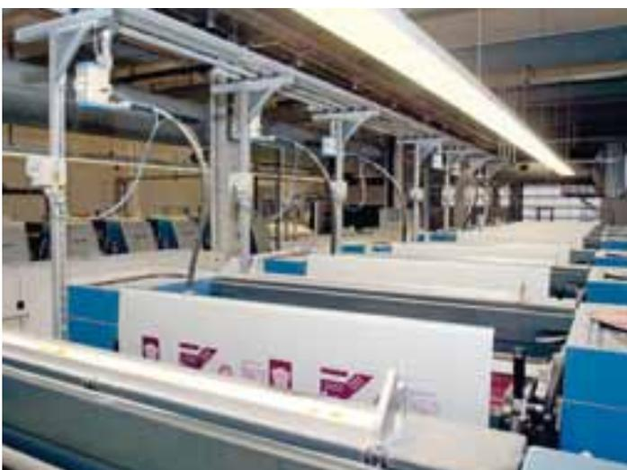
Die Achtefarben-Rapida 106 ist an eine vollautomatische Farbversorgung angeschlossen. Bei der Sechsfarben (im Hintergrund) wurde darauf wegen der häufigen Sonderfarben verzichtet
