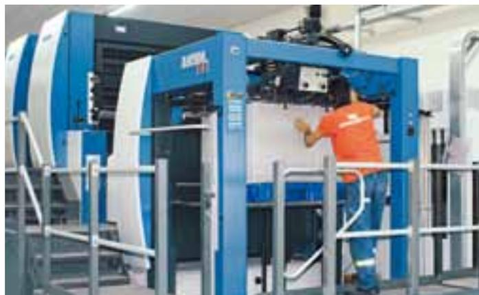
Die im März 2011 bei Kombassan angelieferte Großformatmaschine wurde für den Kartongendruck höher gesetzt
