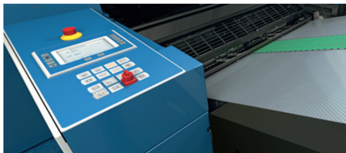
Stół z taśmą ssącą oraz panel obsługi na nakładaniu zespołu drukującego
