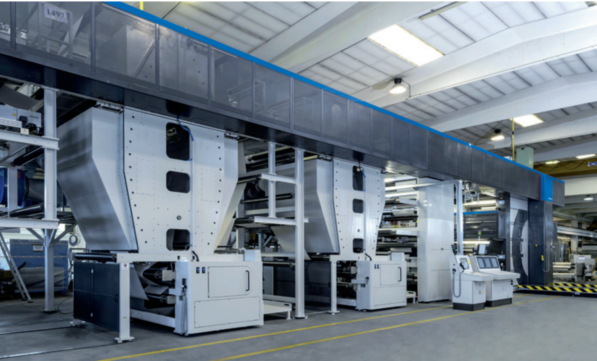
Fleksograficzne jednostki drukujące w linii
