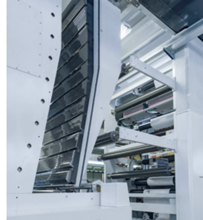
Wysokowydajne suszarki pionowe na zespołach drukujących w linii
