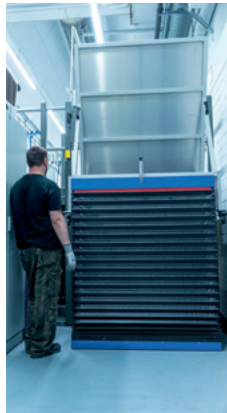
Winda do form transportuje wózek z formami na poziom galerii. Tam trzeba już tylko rozdzielić formy drukowe do poszczególnych zespołów
