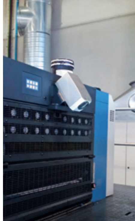
Z zewnątrz kamerę systemu QualiTronic 2 trudno odróżnić od jej wcześniejszej wersji. Nowością jest tu zastosowanie trzech funkcji: porównania arkusza z plikiem PDF, pomiaru kolorystycznego oraz inspekcji arkusza.
