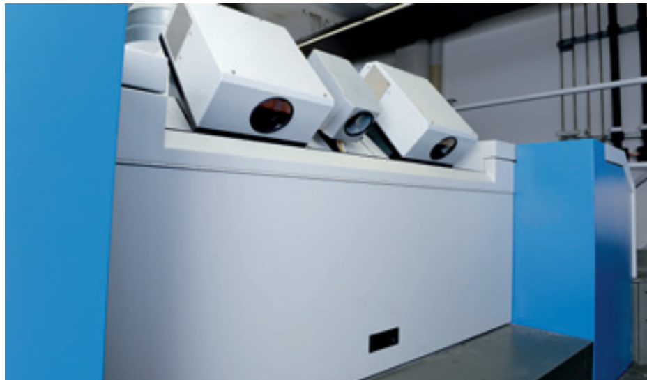
Dodatkowe kamery niezbędne są jedynie w przypadku inspekcji arkuszy realizowanej z rozdzielczością do 300 dpi (QualiTronic PDF HighRes).
