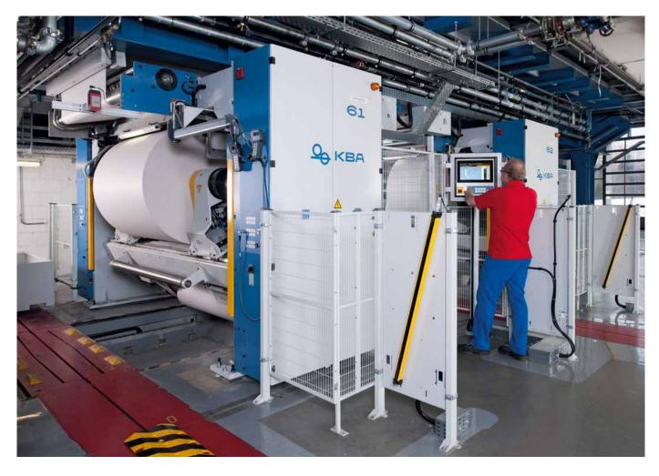
Komfortable Bedienung an dezentralen Displays
