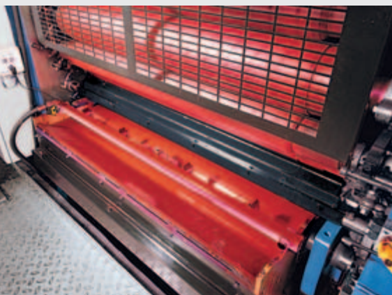
Pneumatisch abschenkbare Farbkästen mit Ausstreifvorrichtung und Auffangwanne für einen schnellen Farbwechsel
